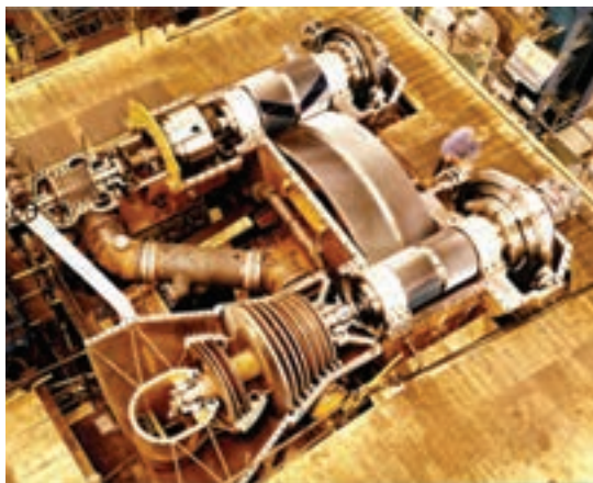
شکل ۲۱- توربین بخار به همراه جعبه‌دنده
