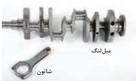
شکل ۱۰- میل لنگ و شاتون
