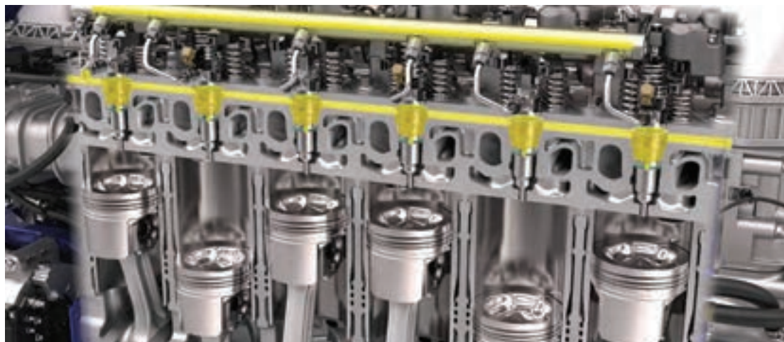
شکل ۲۰- سامانه تزریق سوخت
