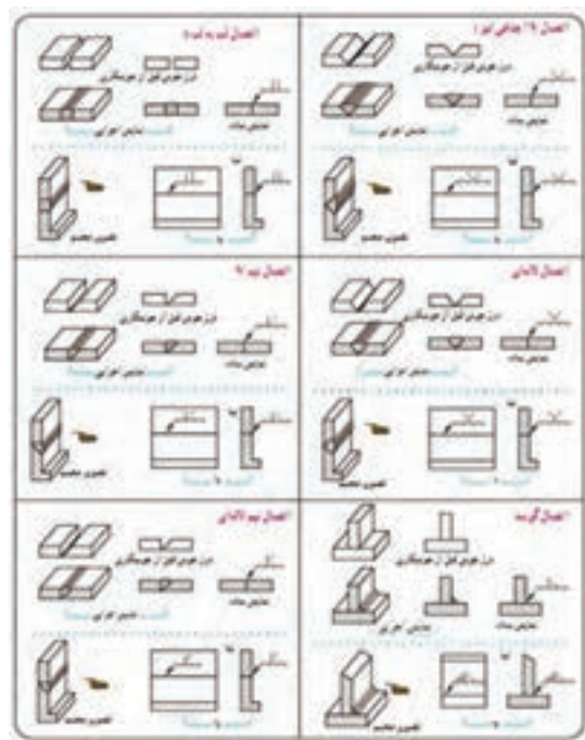
شکل 7- انواع اتصال های جوشکاری
