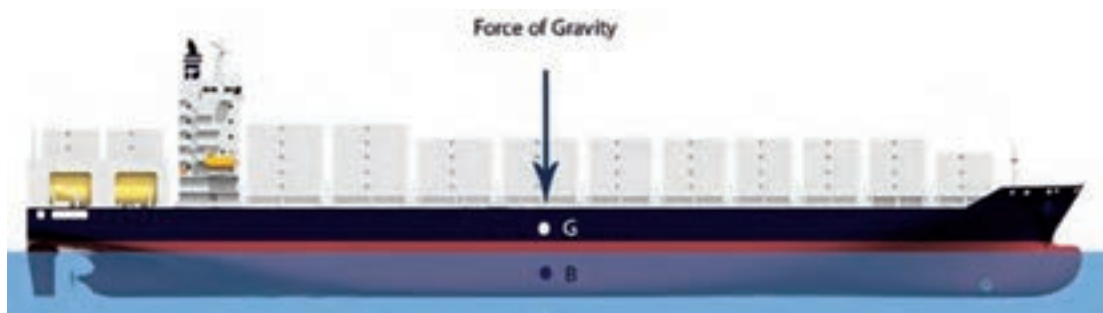
شکل ۶- مرکز ثقل یک شناور
