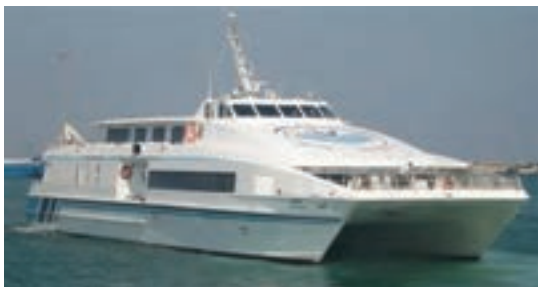
شکل ۱۵- یک شناور کاتاماران با بدنه آلومینیومی
