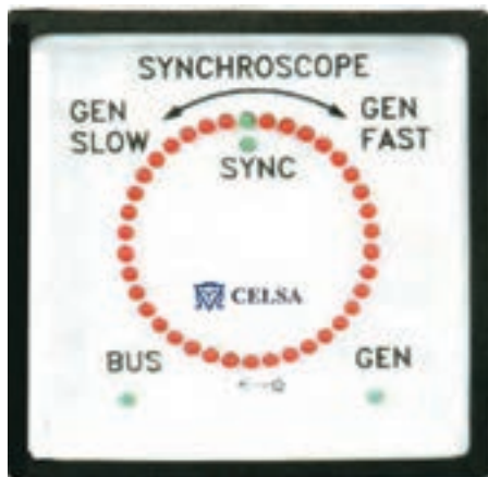
شکل ۲۰- سنکروسکوپ و مدار یک سنکروسکوپ ساده
