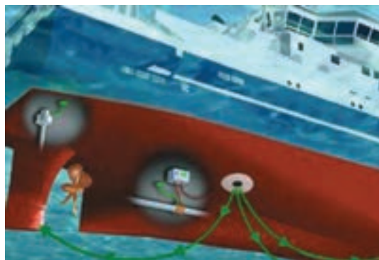
شکل ۳۱- بخش آندی و کاتدی بدنه شناور که در تماس با آب دریاست.
