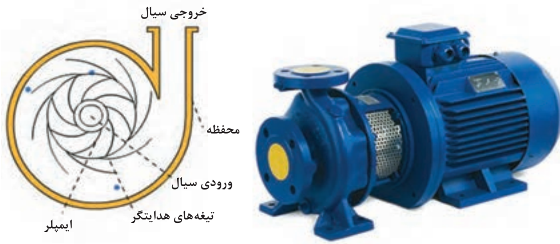
شکل ۵- پمپ گریز از مرکز
