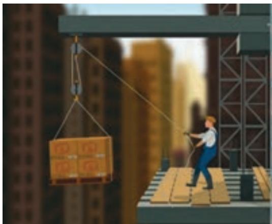
شکل ۲۶- ترکیب دو قرقره برای افزایش بهره مکانیکی
