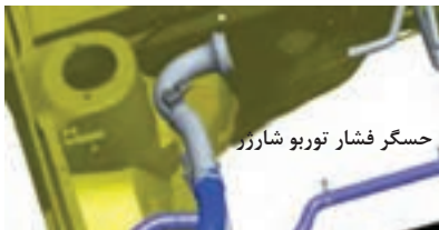
شکل ۳۲- موقعیت حسگر فشار توربو شارژر
