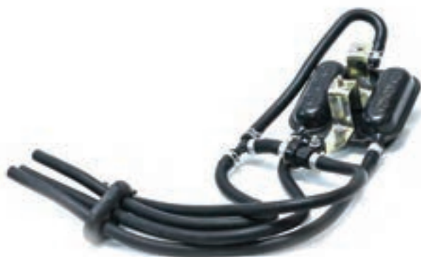
شکل ۶- ساختمان سیستم حباب‌گیر بنزین
