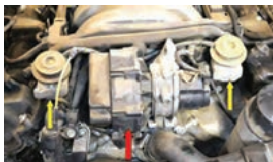
شکل ۵۱- بررسی‌های اتصالات مکانیکی، الکتریکی و خلأئی پمپ دمنده
