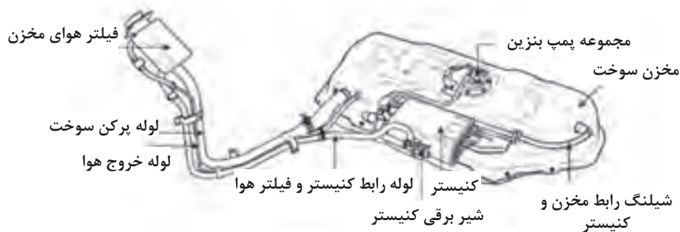
شکل ۳۶- مخزن سوخت و اجزای جانبی آن
