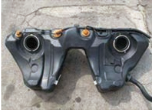
شکل ۷- مخزن سوخت با سوپاپ واژگونی
