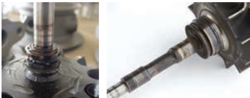
شکل ۸۵- خرابی یاتاقان‌ها و محور توربوشارژر
