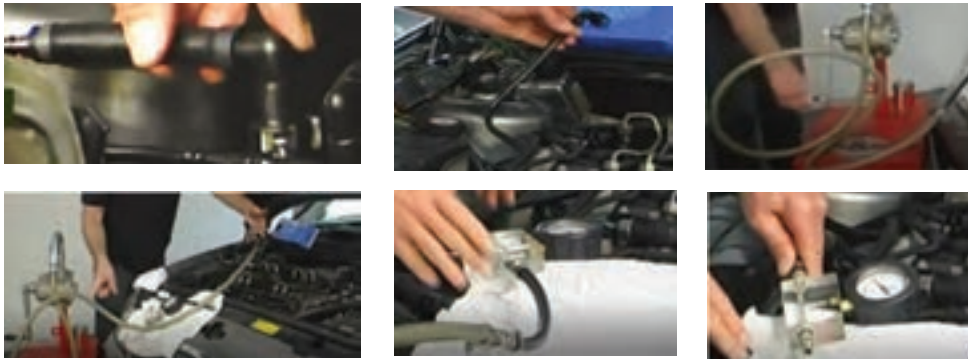
شکل ۵۳ - بررسی و تعویض فیلتر سوخت
