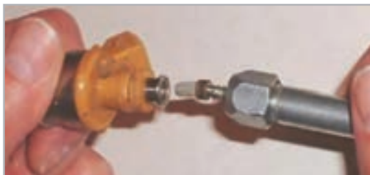
شکل ۷۹- تعویض فیلتر انژکتور
