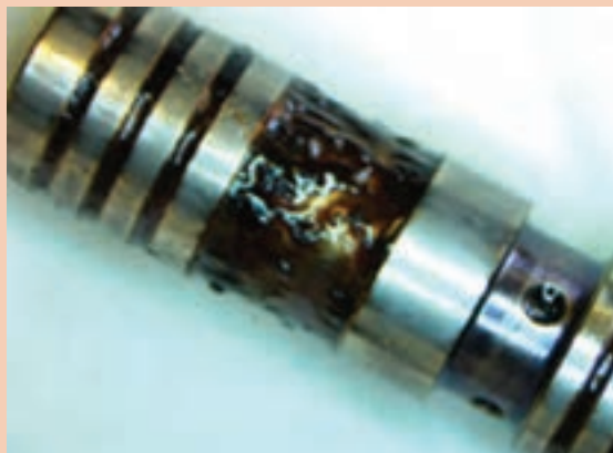
شکل ۷۶- خرابی انژکتور در اثر آب در سوخت
