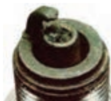
شکل ۳- آسیب به شمع بر اثر خودسوزی
