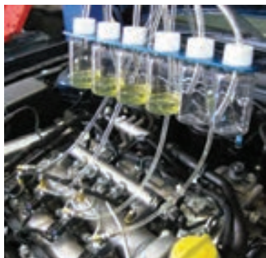
شکل ۵۵- تست اندازه‌گیری مقدار سوخت برگشتی انژکتورها
