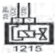
شکل ۵- نماد سوپاپ برقی کنیستر در نقشه‌ها
