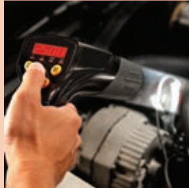
شکل ۲۱- روش کاربری چراغ تایمینگ
