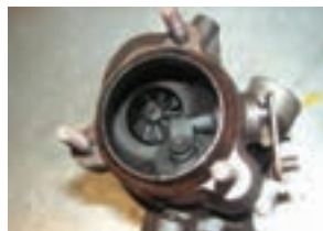
شکل ۸۳- نشستی روغن در توربوشارژر
