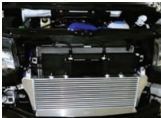
شکل ۸۸- اینتر کولرهای استفاده شده در خودرو
