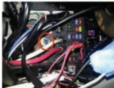
شکل ۵۰- بررسی چشمی اتصالات الکتریکی
