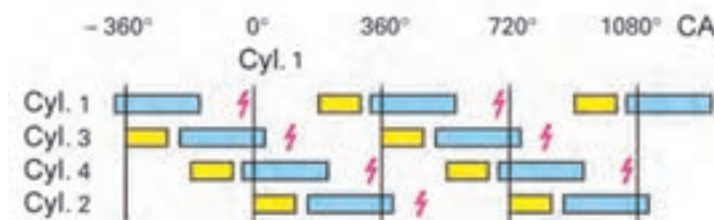
شکل ۲۸- پاشش ترتیبی انژکتورها
