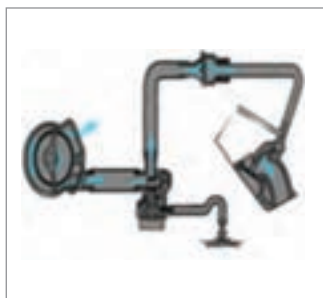
پمپ تزریق ثانویه اسماگ
