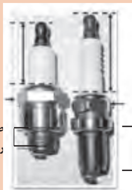
شکل ۱۴- شمع با طول رزوه و آچارخور مختلف
