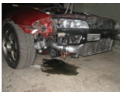
شکل ۴۹- یک نوع نشتی سیستم سوخت‌رسانی
