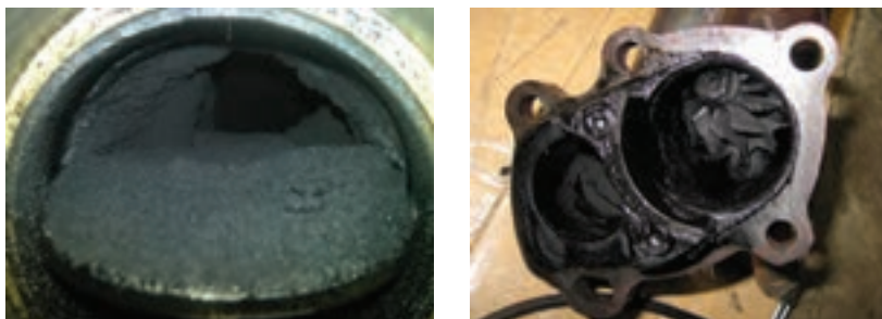
شکل ۸۴- رسوب کربن در ورودی و خروجی توربوشارژر
