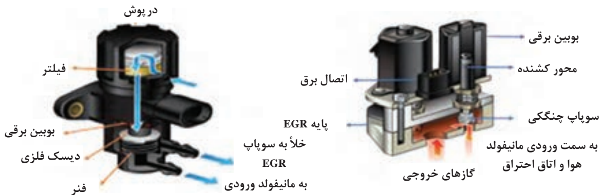
شکل ۱۶- شیر برقی EGR مدل بیرونی و داخلی
