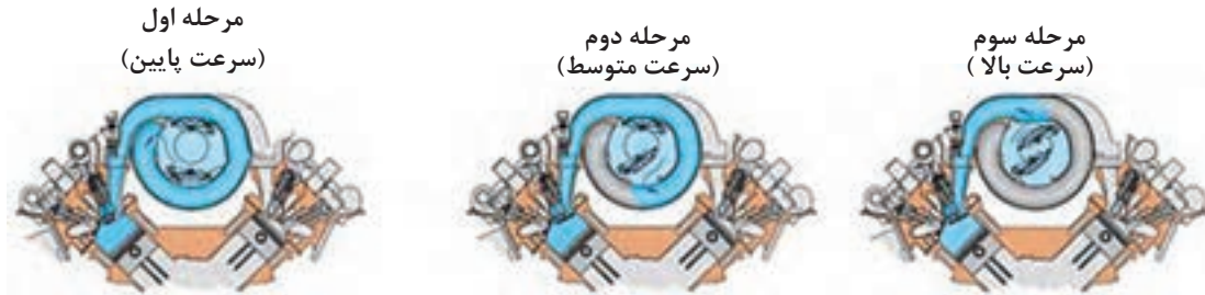
شکل ۴۲- عملکرد سیستم TUMBLE
