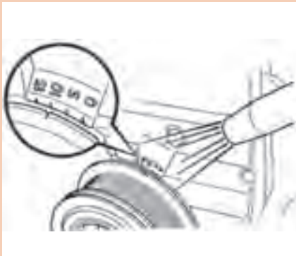
شکل ۲۱- روش کاربری چراغ تایمینگ
