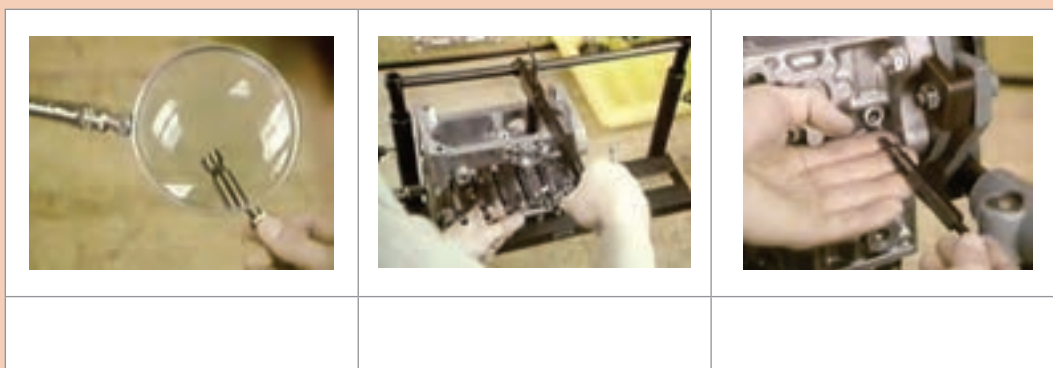
شکل ۶۱- برخی از مراحل سرویس و تعمیر پمپ انژکتور ردیفی
