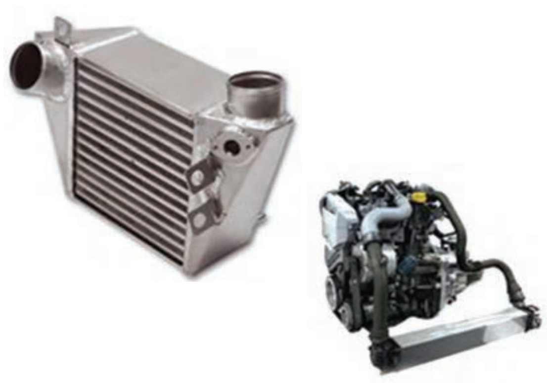
شکل ۳۶- واحد خنک کن هوای ورودی و محل قرارگیری آن
