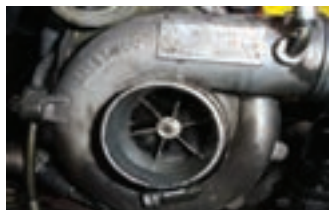
شکل ۸۳- نشستی روغن در توربوشارژر
