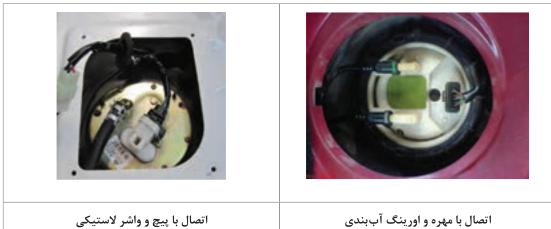
شکل ۶۸- اتصال پمپ‌بنزین به مخزن سوخت
