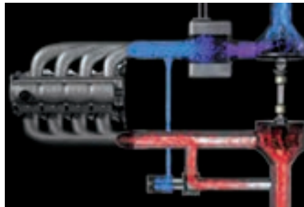
شکل ۲۹- سیستم توربوشارژر
