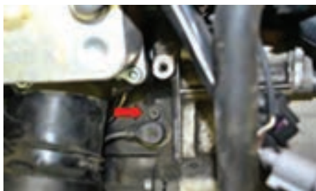
باز کردن فلانچ سیستم اگزوز
