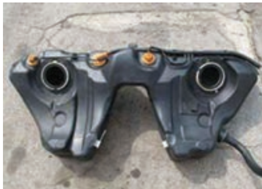
شکل ۷- مخزن سوخت با سوپاپ واژگونی
