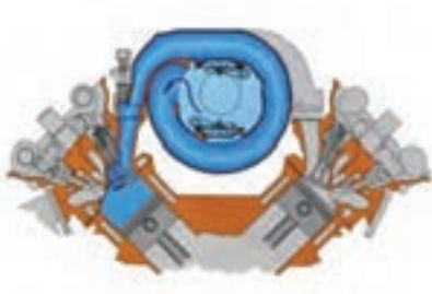
شکل ۴۱- عملکرد سیستم TUMBLE
