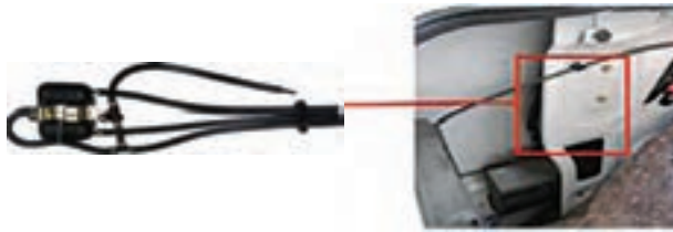
شکل ۴۶- بررسی مجموعه حباب گیر
