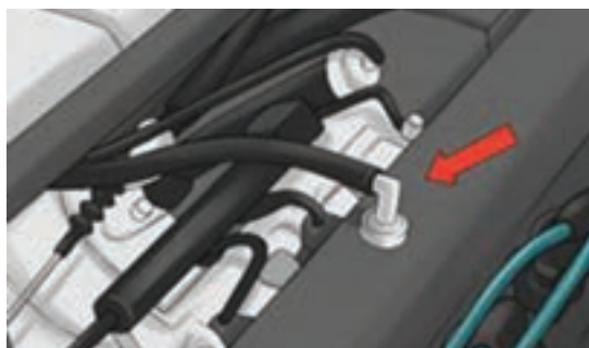
شکل ۱۱- سیستم کنترل آلاینده‌گی محفظه میل لنگ
