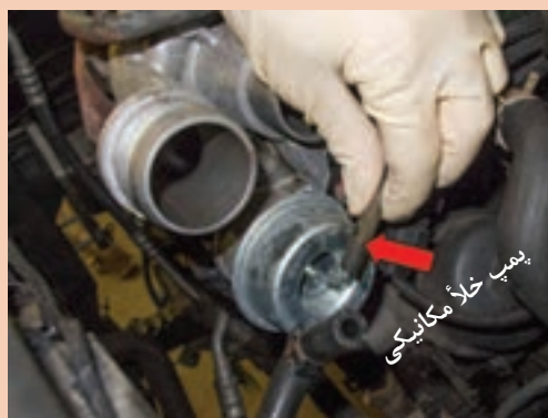
شکل ۳۱- پمپ خلأ مکانیکی
