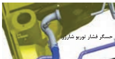
شکل ۳۲- موقعیت حسگر فشار توربو شارژر
