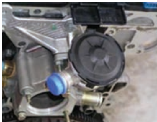
شکل ۲۴- شیر (سوپاپ) پمپ هوا
