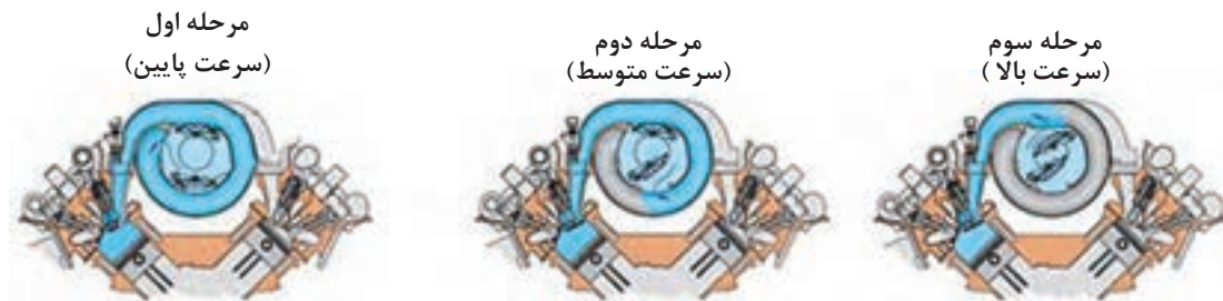
شکل ۴۲- عملکرد سیستم TUMBLE
