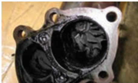
باز کردن فلانچ سیستم اگزوز
