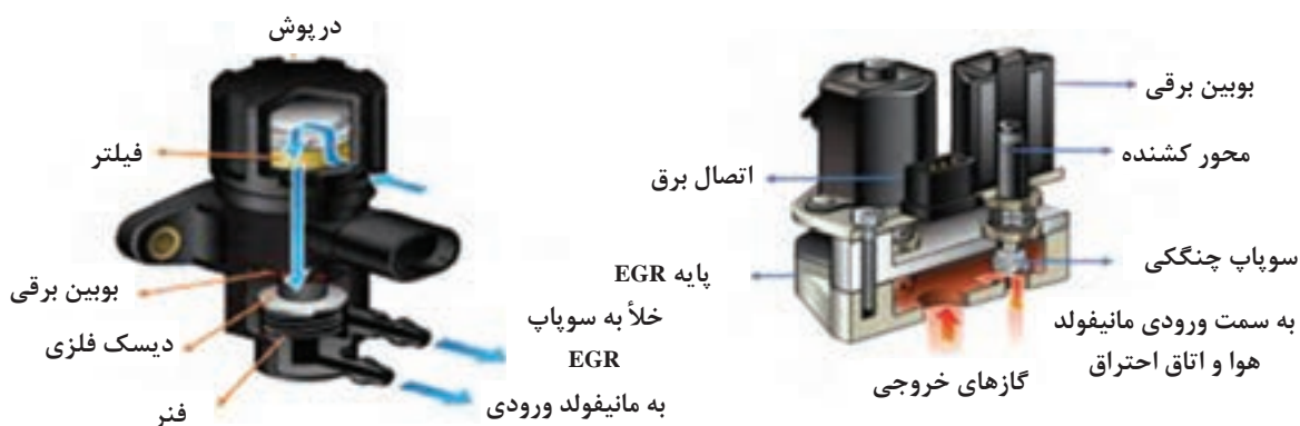
شکل ۱۶- شیر برقی EGR مدل بیرونی و داخلی
