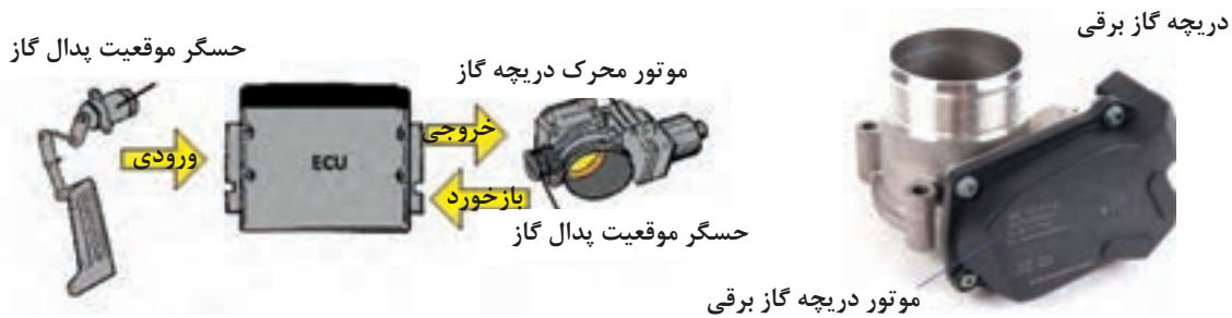
شکل ۳۱- دریچه گاز برقی و سیستم کنترل آن
