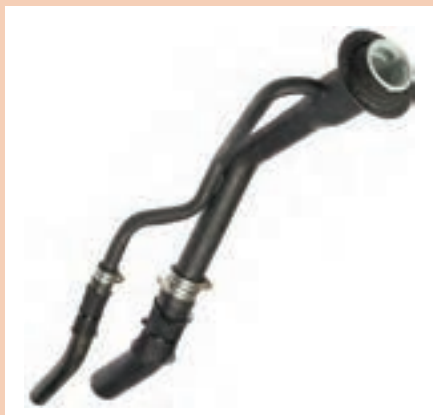
شکل ۳۷- لوله فلزی ورودی و مجرای کناری
