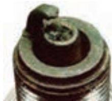
شکل ۳- آسیب به شمع بر اثر خودسوزی
