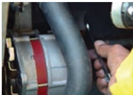
بازکردن پیچ‌های پایه آلترناتور
