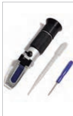
رفراکتومتر، اندازه‌گیری جرم حجمی الکترولیت
