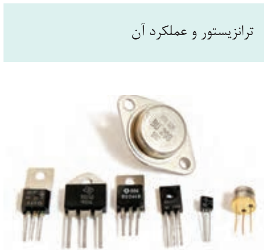
شکل ۲۲- انواع ترانزیستور و عملکرد آن
