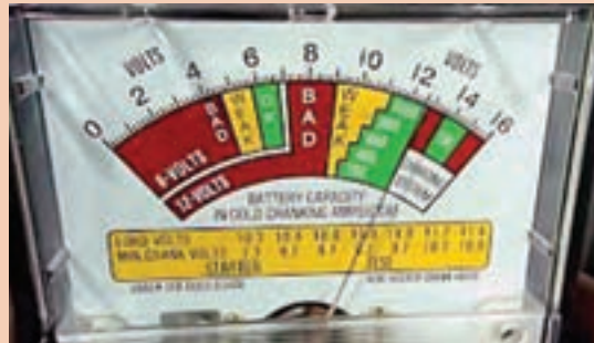
شکل ۵۱- نشان دهنده دستگاه آزمایش باتری
