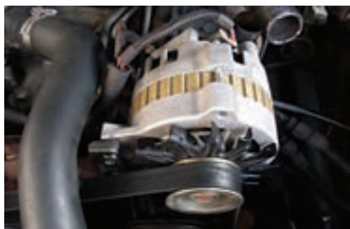
بررسی تسمه از نظر خرابی، پارگی
