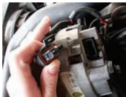
بررسی ظاهری کانکتورها از نظر شکستگی
