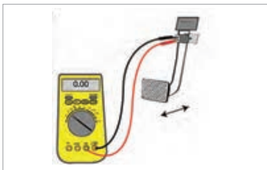
شکل ۳۴- آزمایش فشنگی پدال ترمز (یک نوع کلید)
