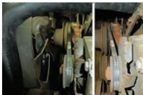
بررسی ناهم‌راستایی تسمه و میزان کشش
