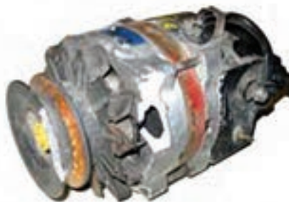
بررسی بدنه از نظر شکستگی یا صدا
