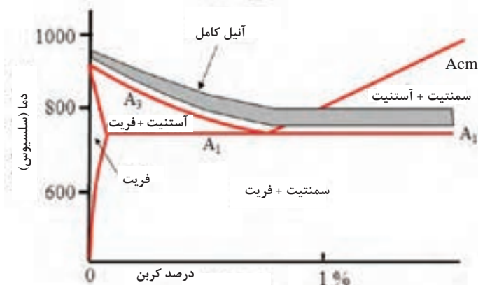
شکل ۱- محدوده دمایی آنیل کامل در فولادها (منطقه خاکستری رنگ)
