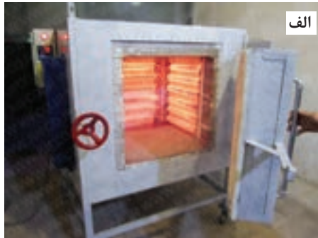
شکل ۵- انواع کوره‌های الکتریکی، الف) بدون فن، ب) فن دار
