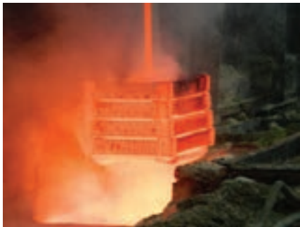
شکل ۳۴- کربوره کردن مایع در حمام نمک
