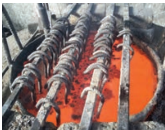
شکل ۲۴- وارد کردن قطعات سیم‌بندی شده در حمام نمک
