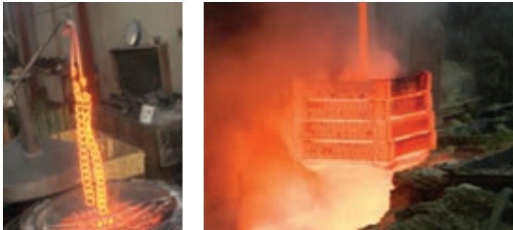
شکل ۲۶- روش های مختلف خارج کردن قطعه از کوره
