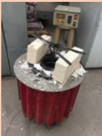
شکل ۲۹- وارد کردن نمونه‌ها در حمام نمک
