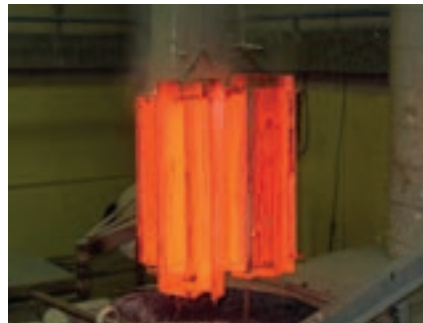
شکل ۳۴- کربوره کردن مایع در حمام نمک
