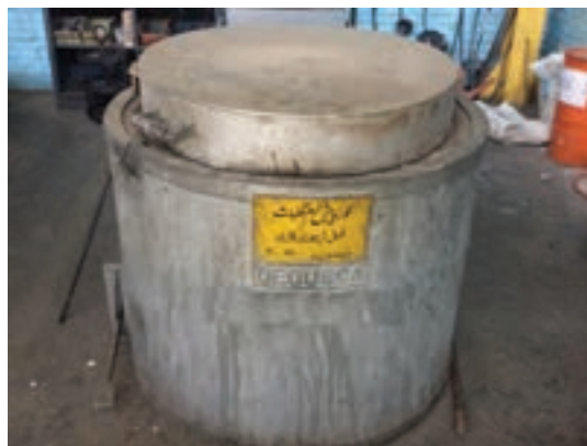
شکل ۲۳- کوره پیش‌گرم قطعات
