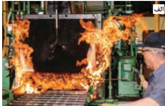
شکل ۲۱- نمونه‌ای از ورود قطعات در کوره‌ها با اتمسفر کنترل شده، (الف) روشن شدن مشعل در کوره هنگام وارد کردن قطعات، (ب) بسته شدن در کوره بعد از وارد شدن قطعات
