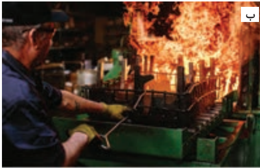
شکل ۲۱- نمونه‌ای از ورود قطعات در کوره‌ها با اتمسفر کنترل شده، (الف) روشن شدن مشعل در کوره هنگام وارد کردن قطعات، (ب) بسته شدن در کوره بعد از وارد شدن قطعات
