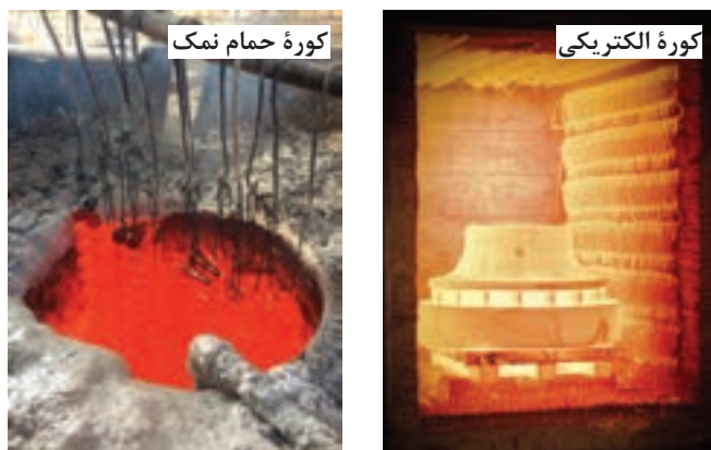
شکل ۲۵- هم‌دما کردن قطعات در کوره‌ها
