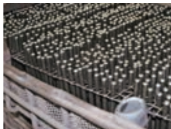
شکل ۱۹- انواع چیدمان قطعات در سبدها و روی صفحه فولادی
