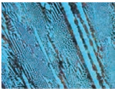
شکل ۳۲- ساختار چدن هیپریوتکتیک (سمنتیت پرویوتکتیک در زمینه لدبوریت)
