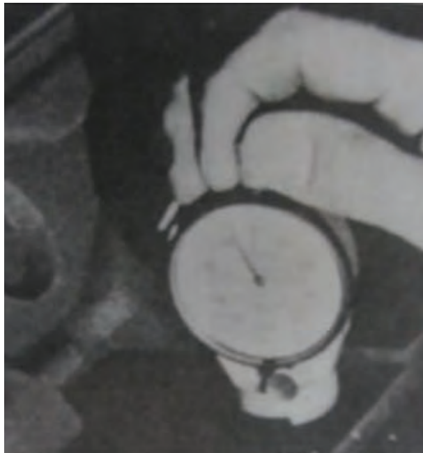
شکل ۳۰- نحوه سختی سنجی سطح قالب
