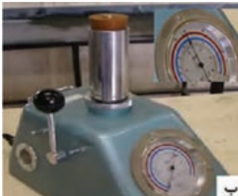
شکل ۳۳- مراحل انجام آزمایش قابلیت نفوذ گاز
