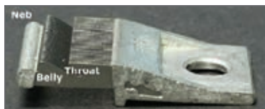
شکل ۳۲ - قالب یک اینچی سینکر
