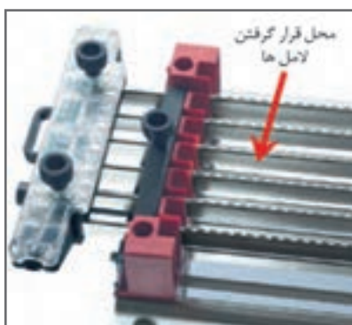
شکل ۷ - انواع لامل‌های ته باز و ته بسته و لامل‌ها روی ماشین بافندگی
