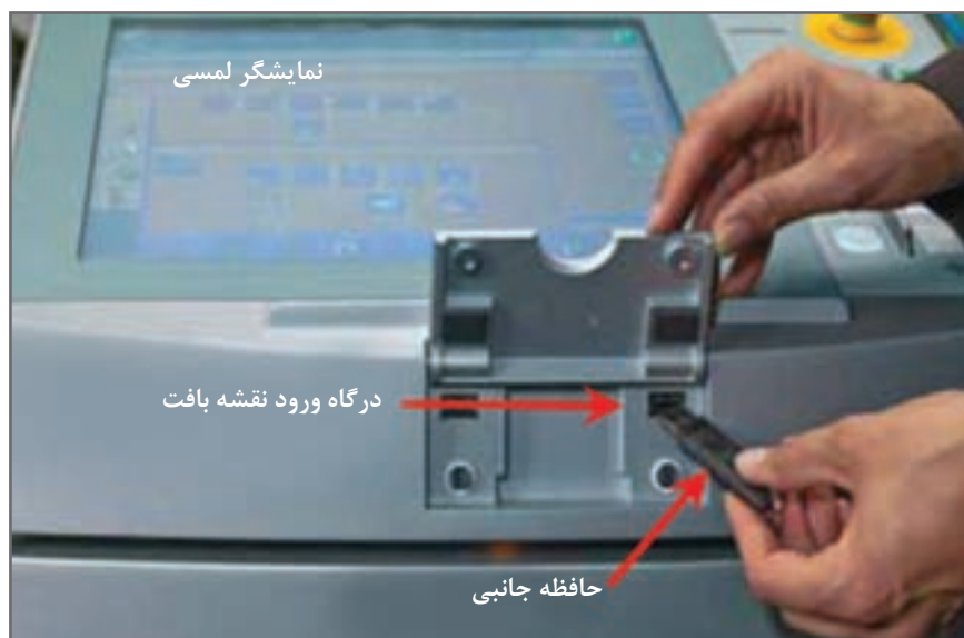
شکل ۳۵- نحوه اتصال حافظه جانبی به ماشین بافندگی
