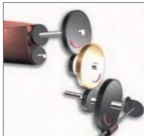
شکل ۲۹- مکانیزم برداشت پارچه متشکل از ۵ چرخ دنده - چرخ دنده های واقعی
