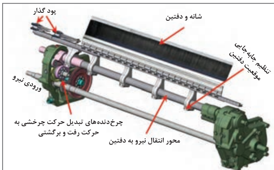
شکل ۲۱- انتقال حرکت دفتین در ماشین بافندگی ایرجت
