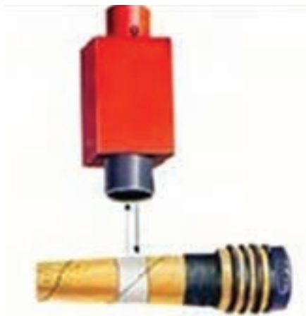
شکل ۸- مکانیزم فتوالکتریکی حس کننده ماسوره خالی
