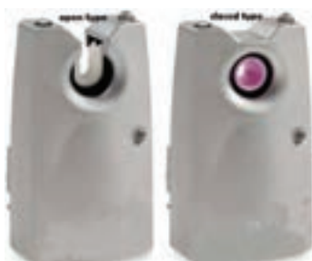
شکل ۳۱- مکانیزم کنترل نخ پود ویبروالکتریک
