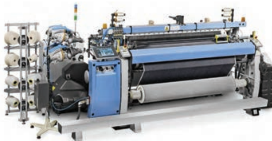
شکل ۲۱- یک دستگاه بافندگی با مکانیزم ایرجت
