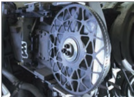
شکل ۱۹- غلک دوران کننده و محرک راپیر
