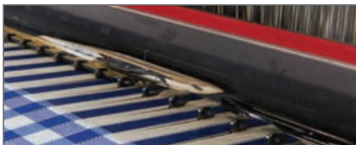
شکل ۱۷- راپیر و راهنماها و نحوه انتقال پود
