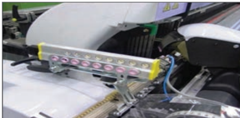
شکل ۲۹- مکانیزم کنترل نخ پود پیزوالکتریک
