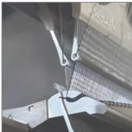
شکل ۳۷- مرحله ۱ قرارگرفتن حلقه روی ساقه سوزن
