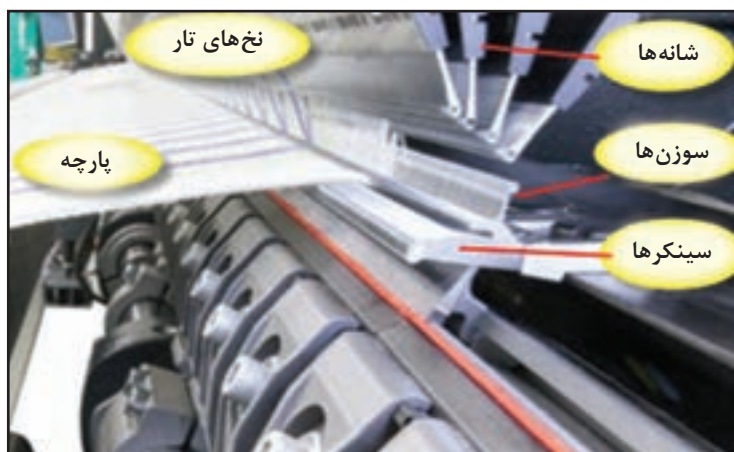
شکل ۲۹- منطقه بافت در یک ماشین واقعی
