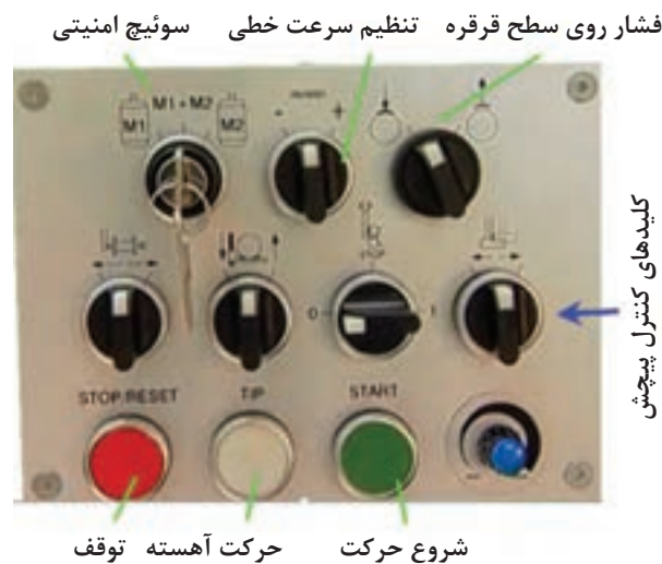
شکل ۱۲ - کلیدهای راه‌اندازی یک دستگاه پیچش قرقره
