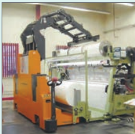
شکل ۱۹ - نحوه انتقال نورد حاوی قرقه‌ها روی ماشین
