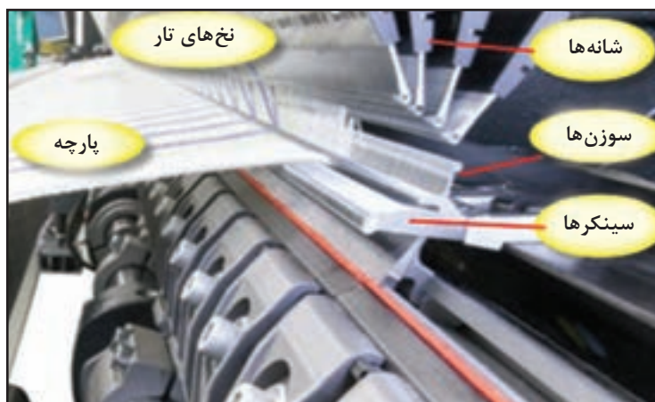
شکل ۲۹- منطقه بافت در یک ماشین واقعی
