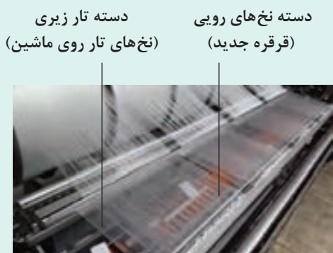
شکل ۲۴ - لایه‌های نخ تار در شاسی ماشین گره زن
