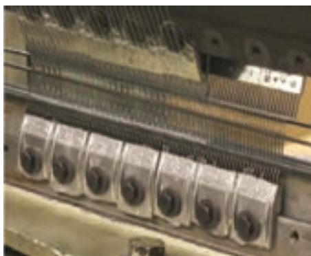
شکل ۳۱ - نصب بلوک سوزن‌ها با پیچ روی صفحه
