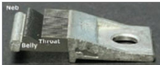
شکل ۳۲ - قالب یک اینچی سینکر
