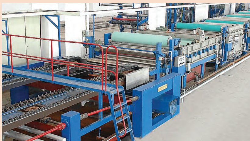
شکل ۱۱- نمای از ماشین مرسریزاسیون زنجیری
