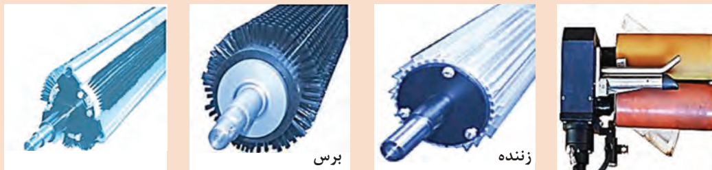
شکل ۲- یک حاشیه‌گیر پارچه و بخشی از برس مویی و زننده و برس و زننده با همدیگر در ماشین پرزسوزی
