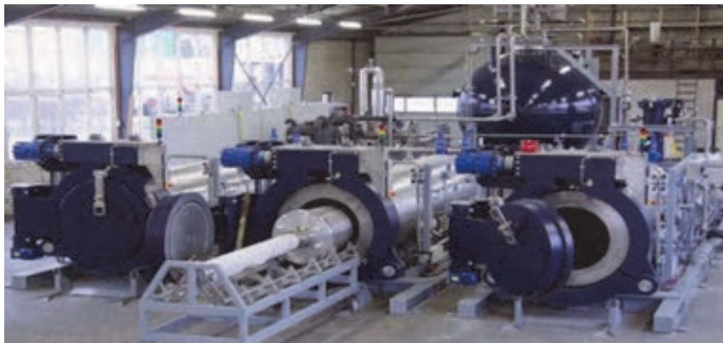
شکل ۲۵- یک نمونه ماشین رنگری فوق بحرانی CO ۲
