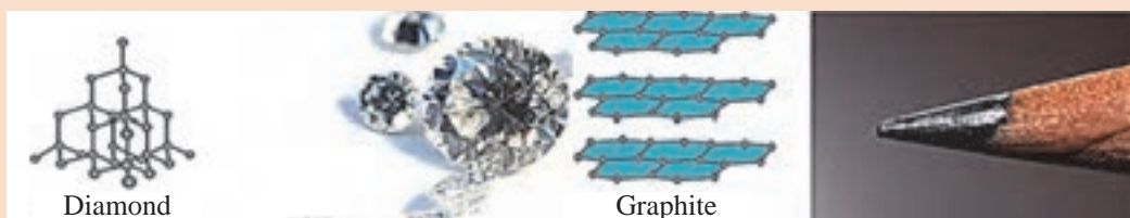
شکل ۲- ساختار گرافیت لایه‌ای و الماس شبکه‌ای
