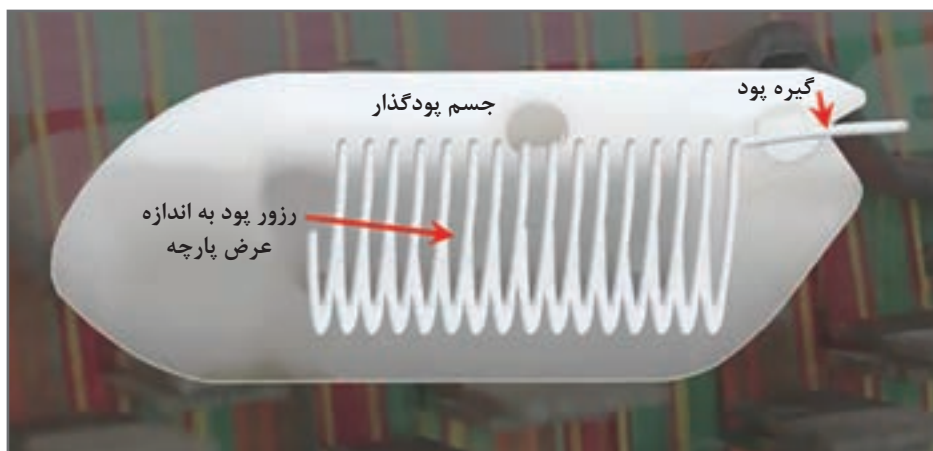
شکل ۳۰- جسم پودگذار و محل ذخیره پود.
