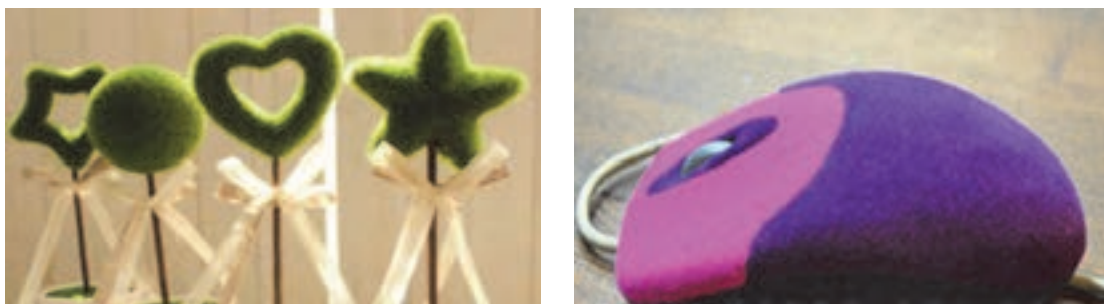
شکل ۱۴- چاپ فلوک روی اجسام مختلف
