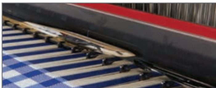
شکل ۱۷- راپیر و راهنماها و نحوه انتقال پود
