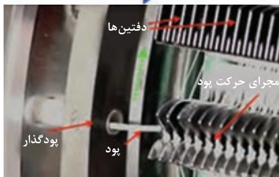
شکل ۳۴- بخش پودگذاری موازی ماشین بافندگی چند فازی ایرجت
