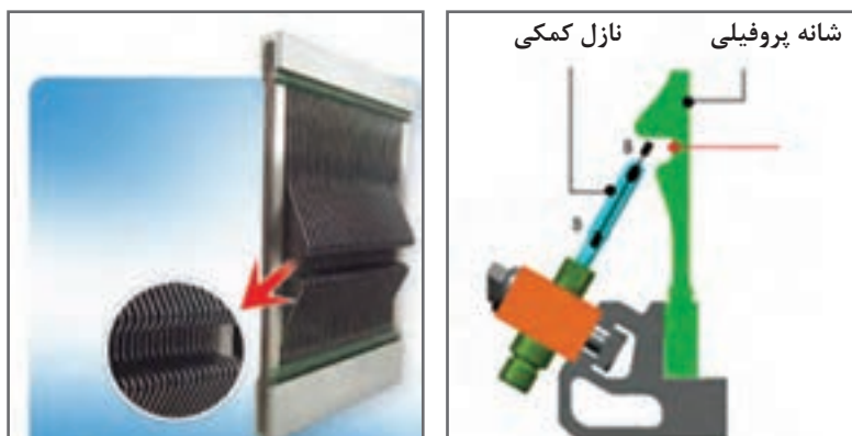
شکل ۲۴- نمای جانبی شانه پروفیلی و جت کمکی
