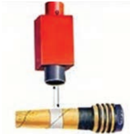
شکل ۸- مکانیزم فتوالکتریکی حس کننده ماسوره خالی
