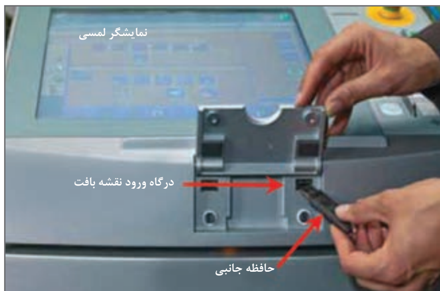
شکل ۳۵- نحوه اتصال حافظه جانبی به ماشین بافندگی
