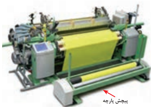
شکل ۱۷- باز شدن نخ تار و پیچش پارچه در ماشین‌های بافندگی
