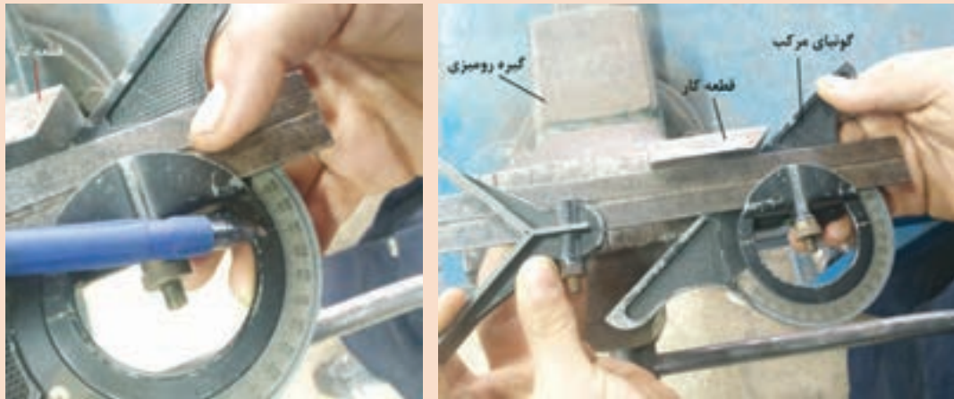
شکل ۲۰- بررسی صحت زاویه با گونیای مرکب
