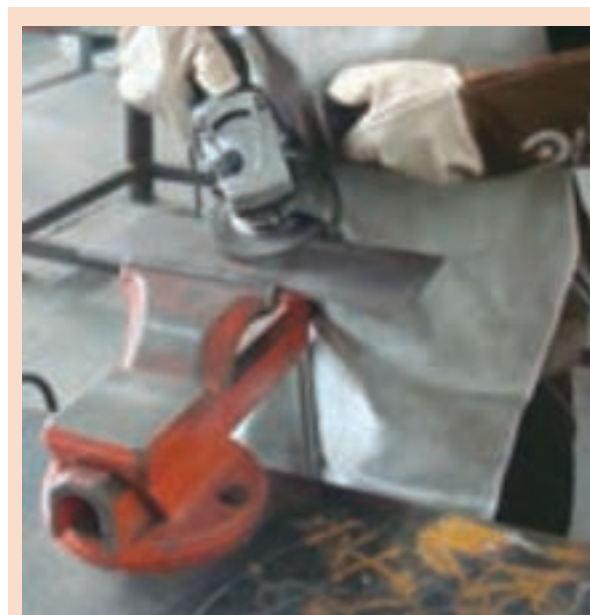
شکل ۱۲- سنگ زدن پشت ورق (ریشه جوش)
