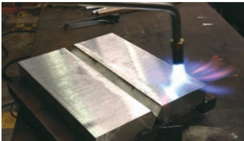
شکل ۵- پیش گرم کردن قطعه ضخیم توسط شعله
