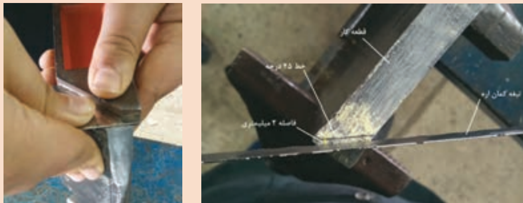
شکل ۱۶-الف) باقی گذاشتن مقداری از ضخامت ورق برای سوهان کاری ب) بررسی صحت زاویه پخ
