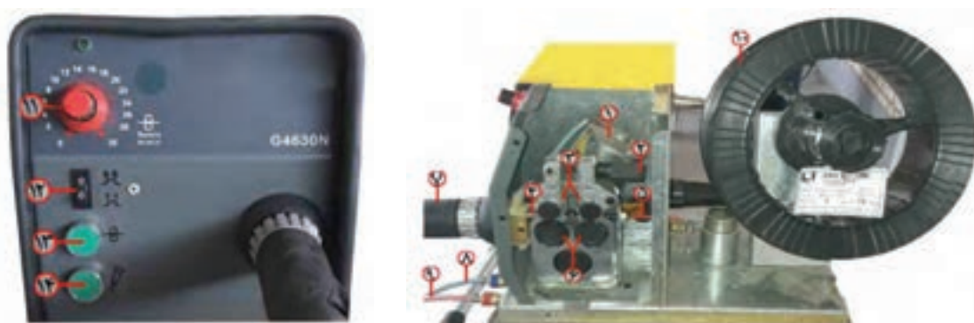
شکل ۱۵- اجزای منبع تغذیه سیم جوش
