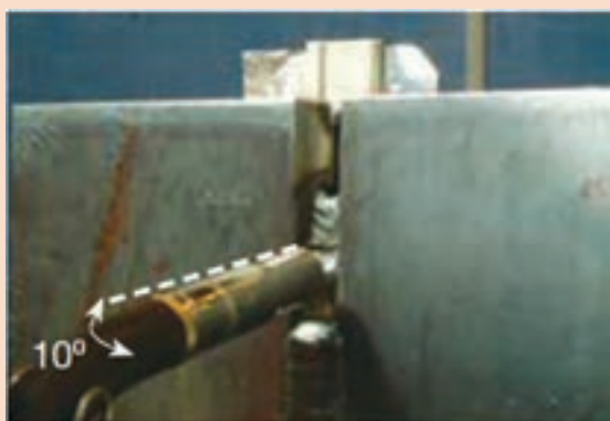
شکل ۲۶- زاویه تورچ و جهت حرکت آن برای انجام پاس سوم
