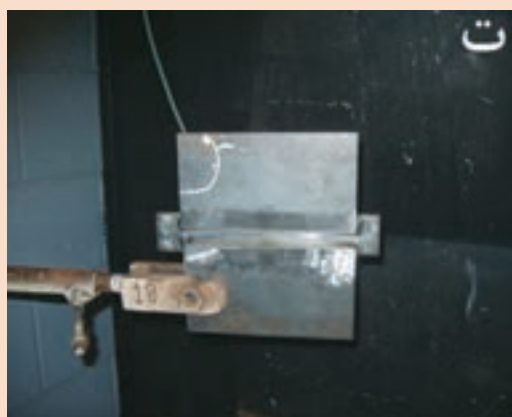
شکل ۱۷- موقعیت دهی و مونتاژ قطعه کار
