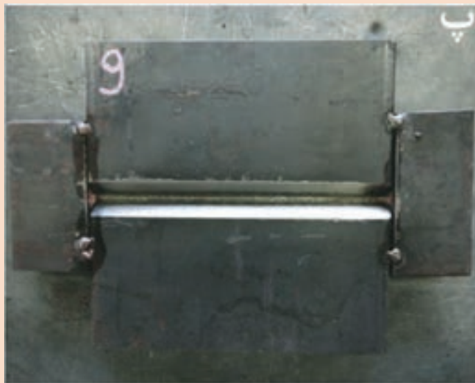
شکل ۲۱- موقعیت دهی و مونتاژ قطعه کار
