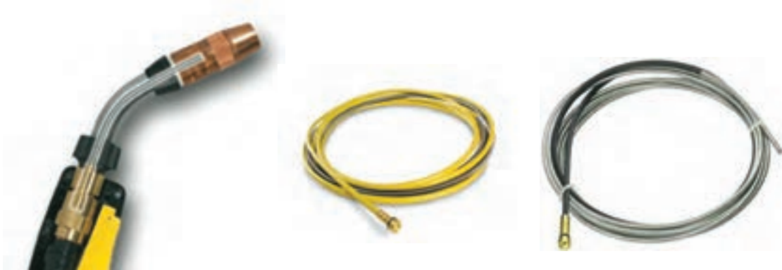
شکل ۱۰- لاینر تورچ جوشکاری GMAW
