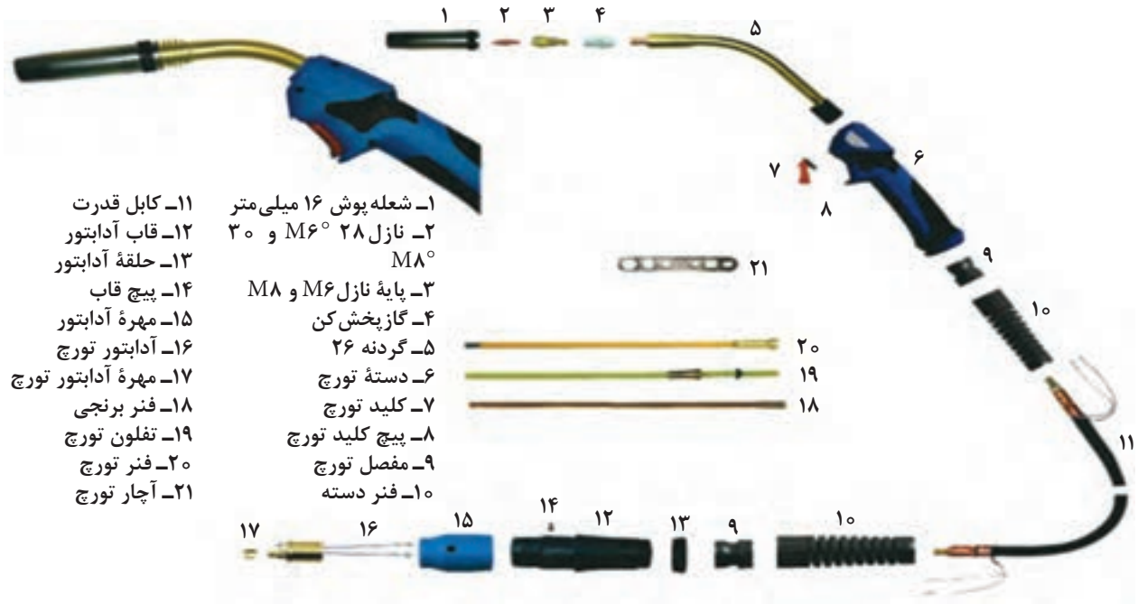
شکل ۷- اجزای تشکیل دهنده تورچ GMAW
