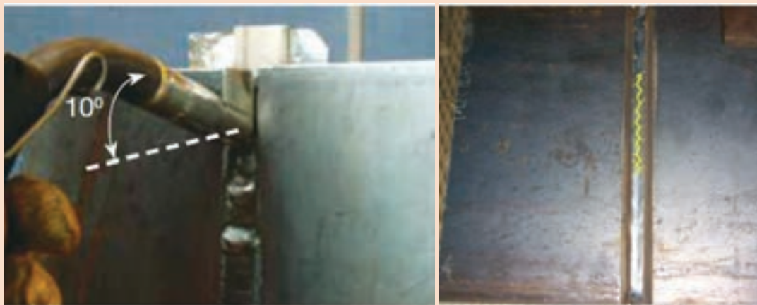
شکل ۲۴- زاویه تورچ و جهت حرکت آن
