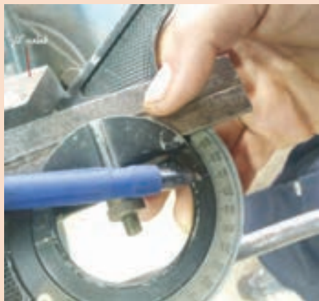
شکل ۲۳- بررسی صحت زاویه با گونیای مرکب
