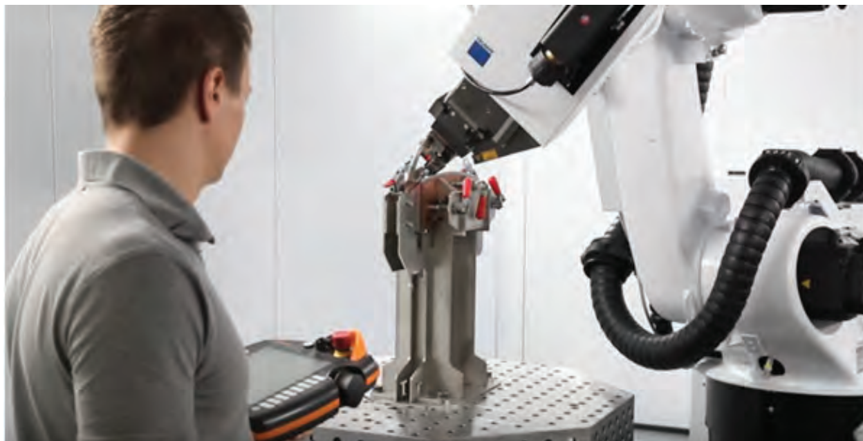
شکل ۲۲: جوشکاری لیزر
