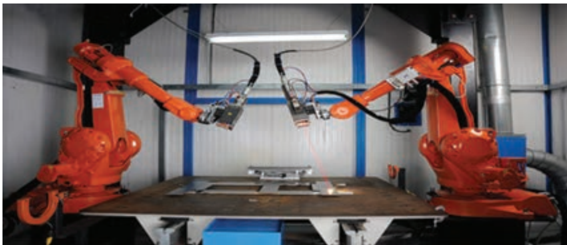
شکل ۳۳: ربات جوشکاری لیزر
