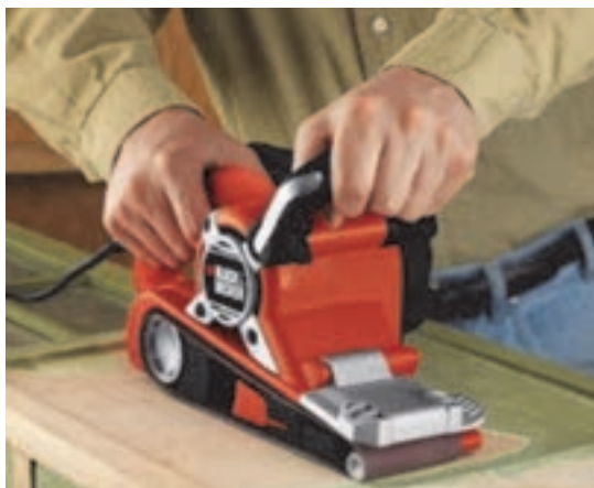
شکل ۵۳- روش کنترل و کاربرد صحیح دستگاه
