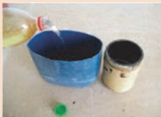
شکل ۸- اضافه کردن نفت به آستری قیری
