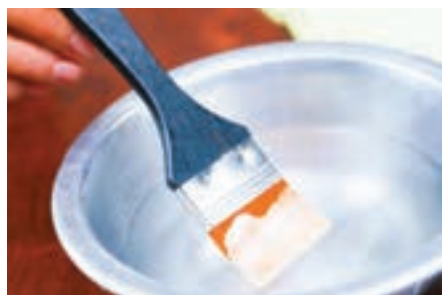
شکل ۳- شستن قلم‌مو با حلال به روش صحیح
