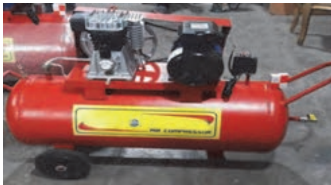
شکل ۱۹۰- هیچ‌گاه کمپرسور را به پهلو نخواستابانید
