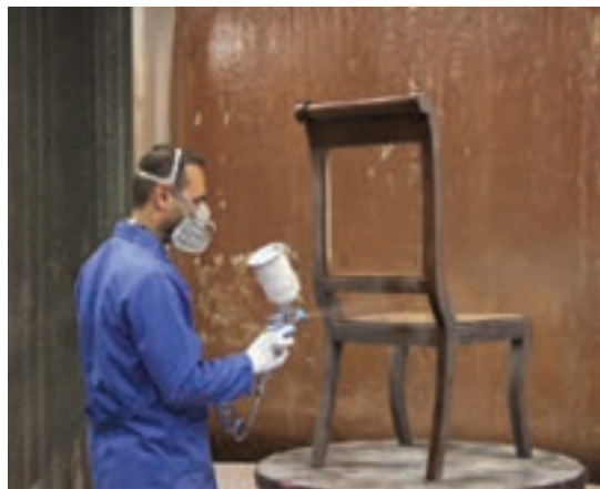
شکل ۱۹- پاشیدن رنگ با پیستوله
