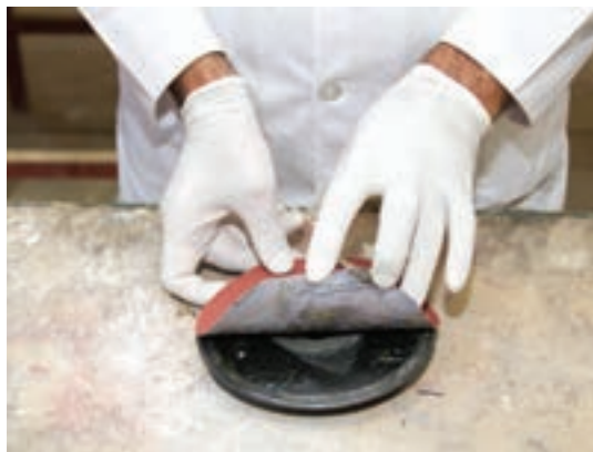
شکل ۱۷۶- چسب زدن به کاغذ سنباده
