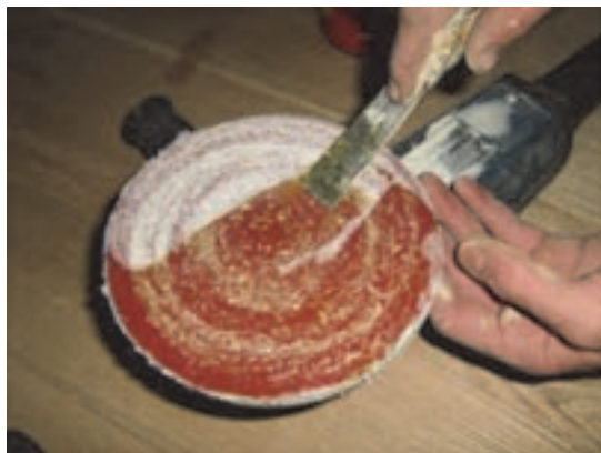
شکل ۱۷۷- چسباندن کاغذ سنباده به سنباده دیسکی
