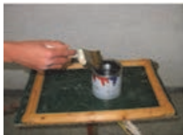
شکل ۸۳- زدن روغن جلا با قلم مو
