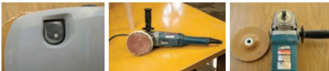
شکل ۱۷۴- اجزای سنباده دیسکی
