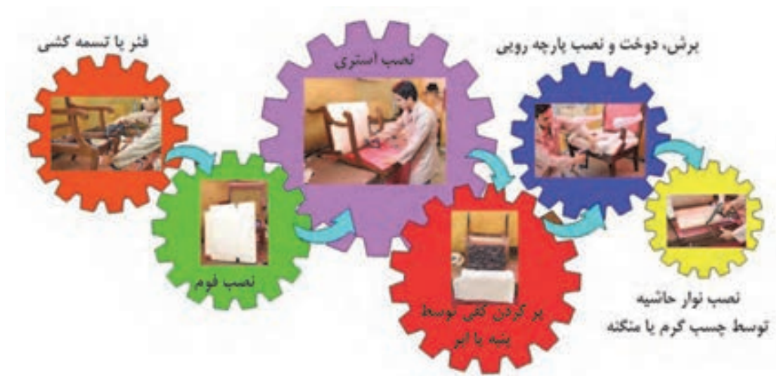
شکل ۲- مراحل اجرای رویه کوبی
