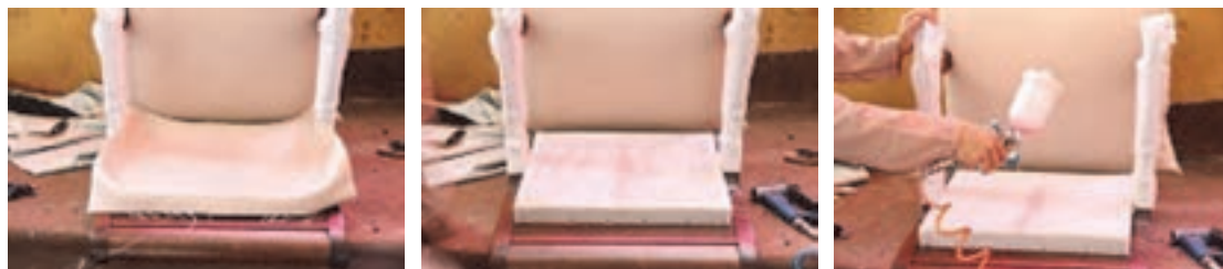
شکل ۳۸- مراحل رویه‌کوبی پشتی مبلمان
