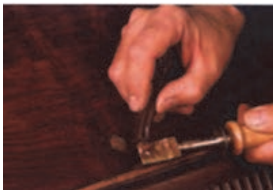
شکل ۹۰- بتونه مومی را به کمک مغار به خلل و فرج چوب وارد می‌کنند
