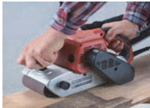
شکل ۴۸- سنباده کاری تخته‌های پهن
