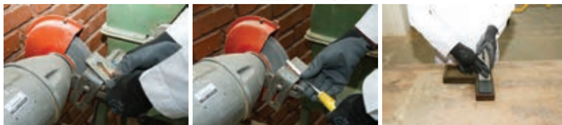
شکل ۳- تیز کردن تیغه رنده به صورت اصولی
