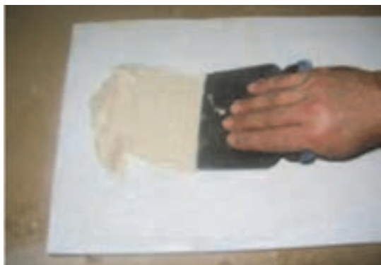
شکل ۹۱- ساخت بتونه سریشی
