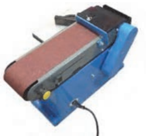
شکل ۵۲- با این پیچ می توان غلطک را حرکت داد
