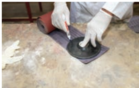
شکل ۲۹- ترسیم گردی دیسک روی سنباده
