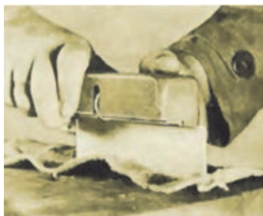
شکل ۶۲- مصقل کشی در لیسسه با رنده مصقل
