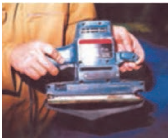
شکل ۴۷- شل شدن کاغذ سنباده
