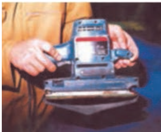
شکل ۴۷- شل شدن کاغذ سنبناده
