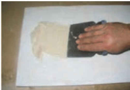
شکل ۹۱- ساخت بتونه سریشی
