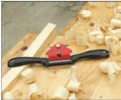
شکل ۵۸- نصب لیسسه به رنده بال کبوتری
