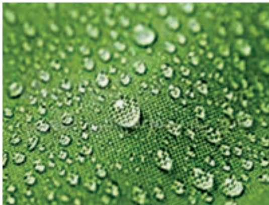
شکل ۱۸- سطح آب گریز: الف) مصنوعی، ب) طبیعی
