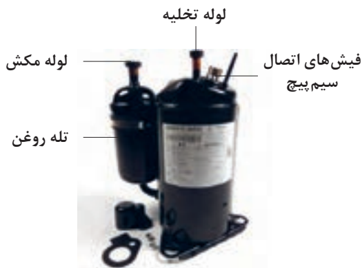
شکل ۱۶- اجزای خارجی کمپرسور
