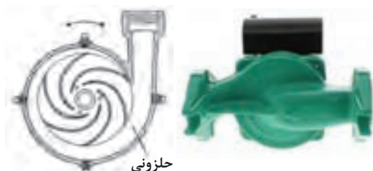
شکل ۷- پوسته حلزونی در پمپ خطی و زمینی
