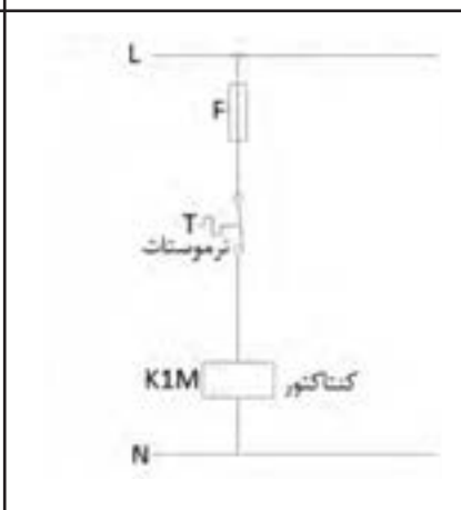
مدار برق موتور یونیت هیتر با کنتاکتور و ترموستات
