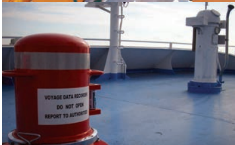
شکل ۱۸- کیسول‌های حاوی DRU نصب شده در عرشه آزاد
