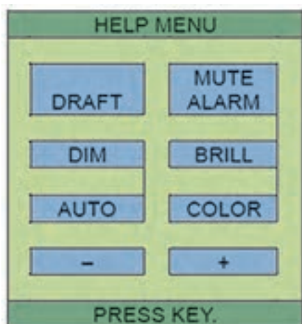
شکل ۳۴- نمایی از نمایشگر عمق‌یاب در حالت HELP
