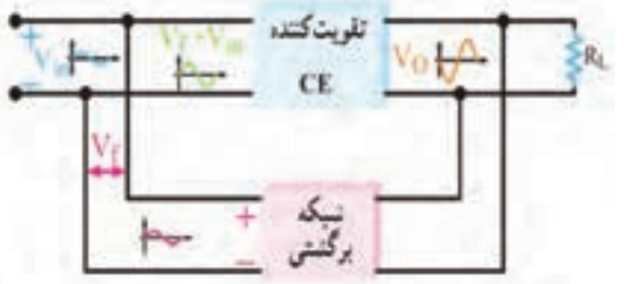
شکل ۱۷-۱۰- بلوک دیاگرام تقویت کننده با فیدبک مثبت
