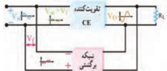
شکل ۱۸-۱۰- بلوک دیاگرام تقویت کننده با فیدبک منفی
