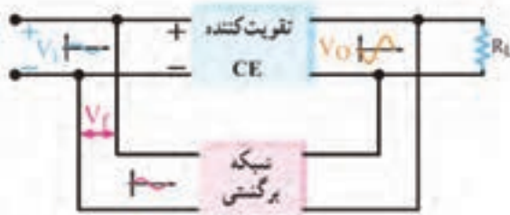
شکل ۱۶-۱۰- بلوک دیاگرام تقویت کننده با فیدبک
