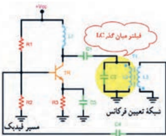
شکل ۴۴-۱۰- نوسان ساز آرمسترانگ
