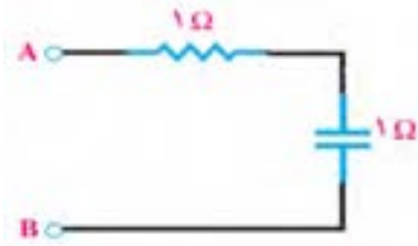
شکل ۹-۶۸- مدار RC سری
