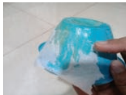
شکل ۴۵-۵- گذاردن لایه‌های دستمال کاغذی آغشته به چسب سریشم روی قالب.
