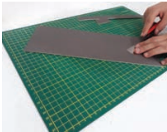
شکل ۱۱۰-۵- اجرای شیپارهای رامپ با کاتر و فشار دست
