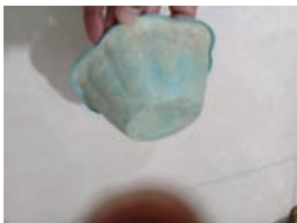
شکل ۴۶-۵- جداسازی پوشش از قالب اصلی
