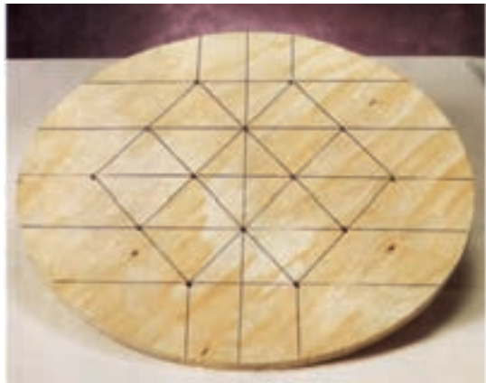
شکل ۴-۵۶- خط‌کشی برای لمسه کاری
