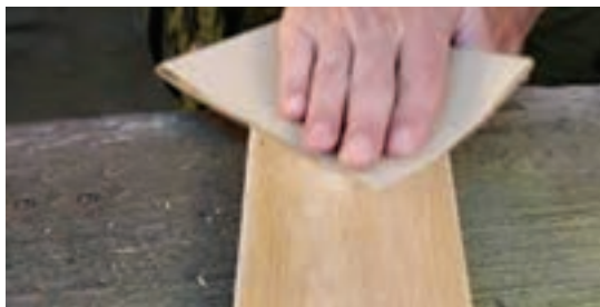
شکل ۴-۲۰- پرداخت با سنباده
