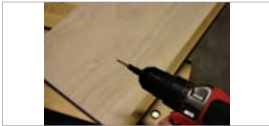
شکل ۴-۵۴- سوراخکاری با مته خزینه دار
