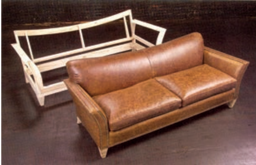
شکل ۴-۱- کلاف مبلمان قبل و بعد از پوشش با پارچه یا چرم
