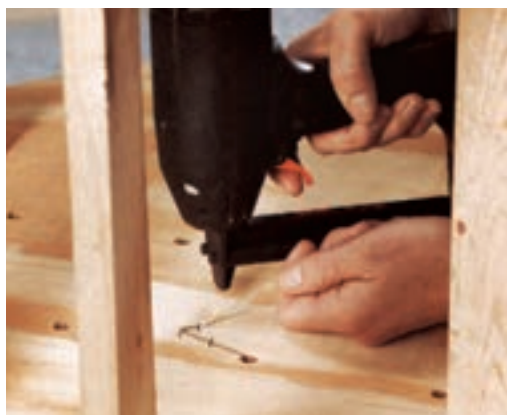
شکل ۴-۶۰- ثابت کردن نخ لمسه از پشت تخته
