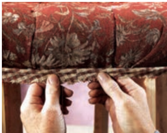
شکل ۴-۶۹- اندازه گیری و نصب سرمه
