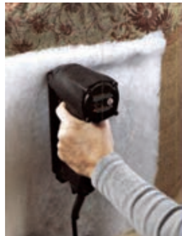
شکل ۴-۶۶- کوبیدن اسفنج بدنه
