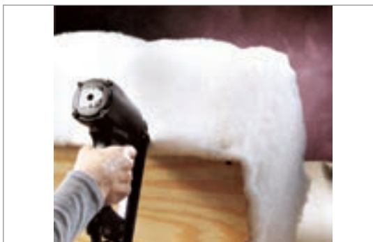
شکل ۴-۳۹- نصب اسفنج به بدنه صندوقچه
