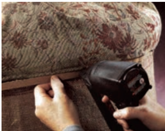
شکل ۴-۷۰- کوبیدن زهوار زیر سرمه با منگنه
