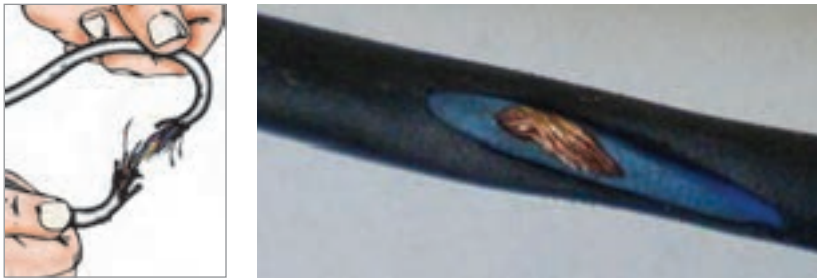
شکل ۱۸-۳- پوسیدگی و زخمی شدن سیم‌ها و کابل‌ها
