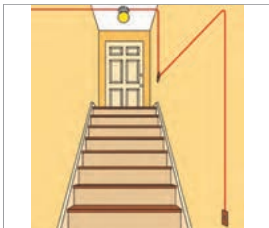
شکل ۳-۳۷- مدار الکتریکی کلید تبدیل
