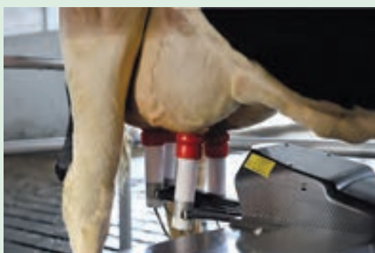
شکل ۵۵- اتصال مکندۀ ربات و آغاز فرایند شیردوشی
