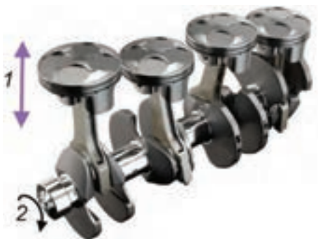
شکل ۱۹- کاربرد مکانیزم لنگ و لغزنده در موتور
