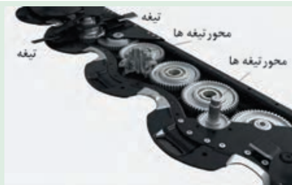
شکل ۵۱ - چرخ دنده‌های محرک تیغه‌ها در دروگر بشقابی
