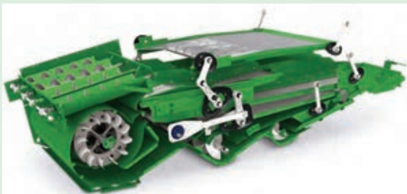
شکل ۶۷ - واحدهای عملیاتی کمباین
