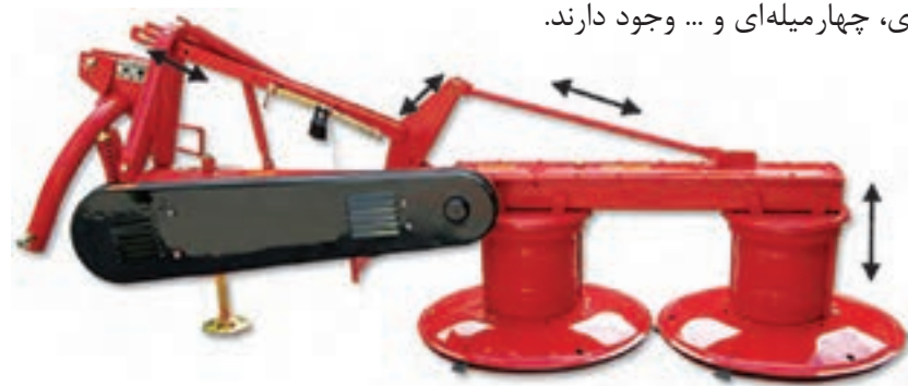
شکل ۴- مکانیزم میله‌ای در دروگر
