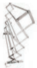
شکل ۶- میله‌ها و مفصل‌های اتصال سه نقطه تراکتور
