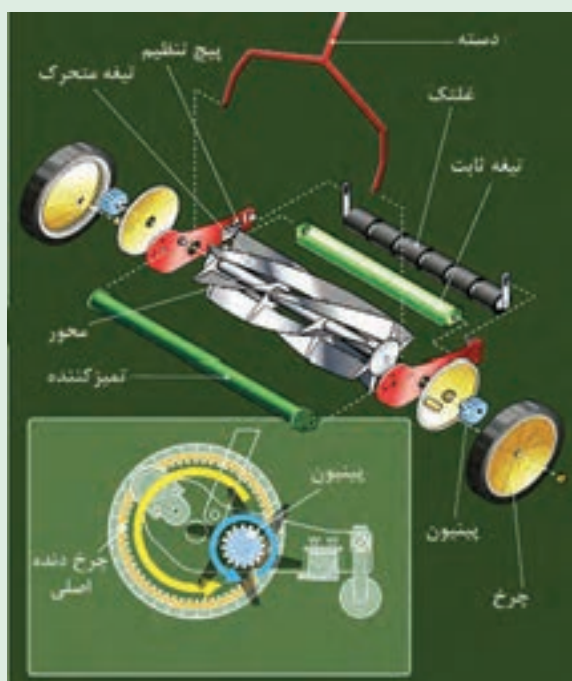
شکل ۴۶- کاربرد مکانیزم چرخ دنده‌ای در چمن‌زن دستی
