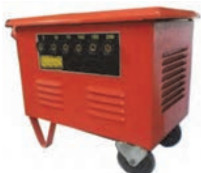
شکل ۸- ترانس با مکانیزم تغییر آمپر پله‌ای
