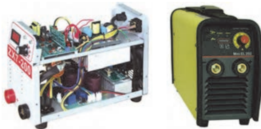
شکل ۱۳- اینورتر جوشکاری و اجزای داخلی آن
