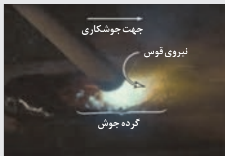
شکل ۳۹- جوشکاری با زاویه پیشران
