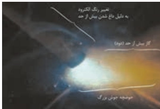
شکل ۲۷- جوشکاری با آمپر بسیار بالا
