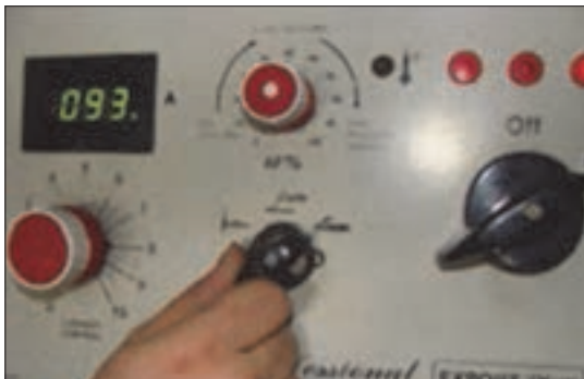
شکل ۱۲- کلیدهای مختلف برای تنظیم دستگاه جوشکاری
