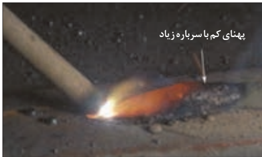
شکل ۳۰- جوشکاری با طول قوس بسیار کم
