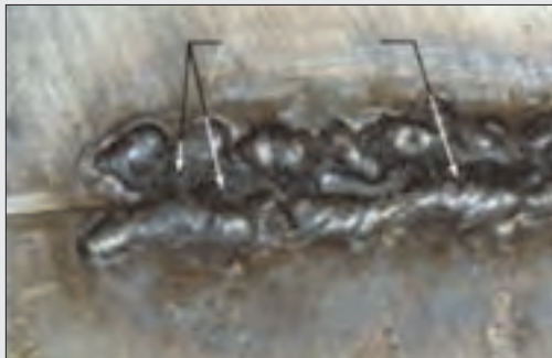
شکل ۵۱- عیب ایجاد شده در اثر حرکت سریع الکترود در عرض جوش
