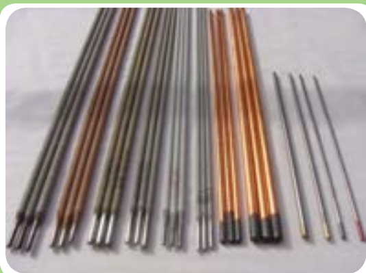
سه نوع الکتروود (تنگستنی، ذغالی و روپوش‌دار) مورد استفاده در فرآیندهای جوشکاری قوسی
