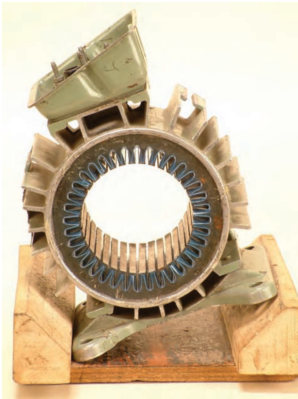
شکل ۲۹-۲-ب - انتخاب شیار شروع سیم‌بندی
