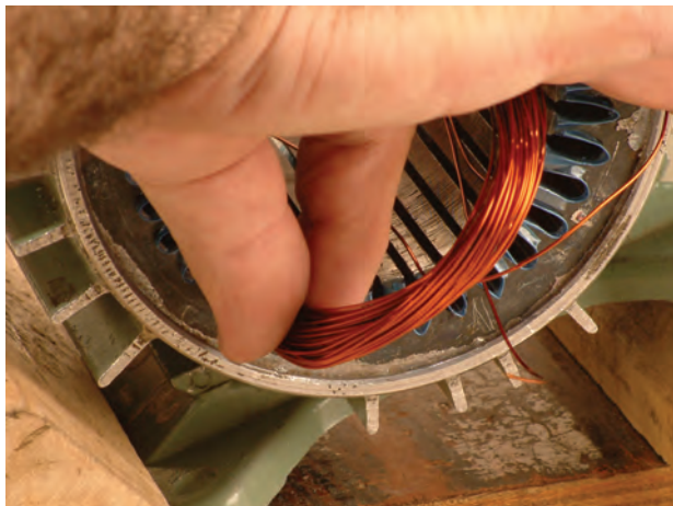
شکل ۲-۱۵- قراردادن بازوی شماره یک در شیار شماره ۱
