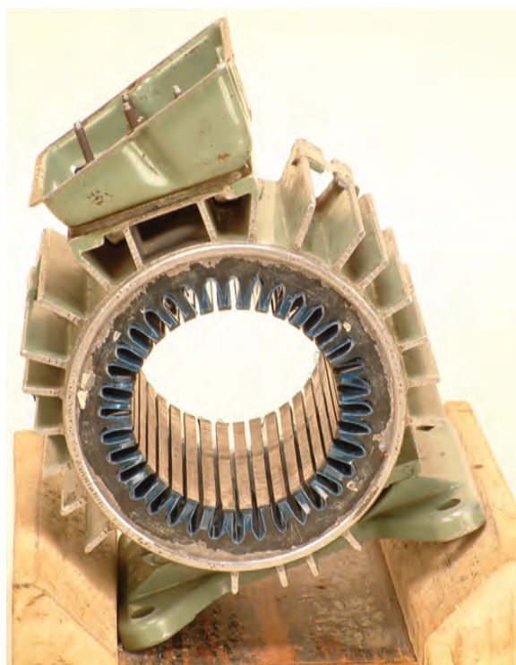
شکل ۱۳-۲- انتخاب شیار شروع و مسیر کلاف‌گذاری
