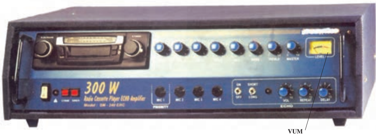
شکل ۱-۳- ابزار سنجش VUM در یک آمپلی فایر
