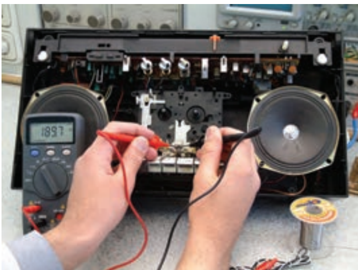
شکل ۱-۴۹- اندازه‌گیری مقاومت هد برای تعیین قطع‌شدگی، اتصال کوتاه و یا اتصال به نقطه‌ی زمین
