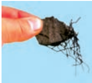
شکل ۱-۱- آهنربای طبیعی براده‌های آهن را جذب می‌کند.
