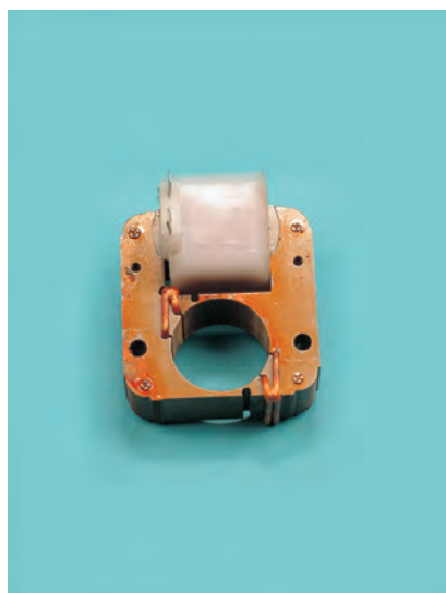
شکل ۲-۲- استاتور موتور قطب چاکدار
