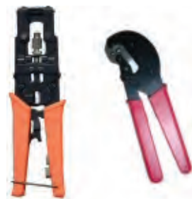
شکل ۳-۳۶ دستگاه پرس BNC
