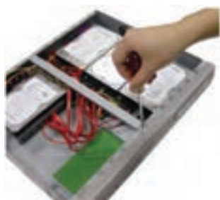
شکل ۶۸-۳ دیسک سخت نصب شده در داخل دستگاه
