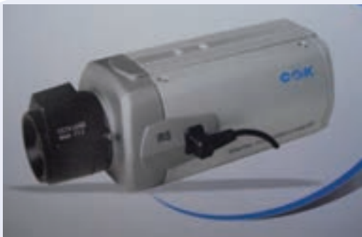
شکل ۳-۲۲ اتصال کابل لنز اتوایریز به دوربین
