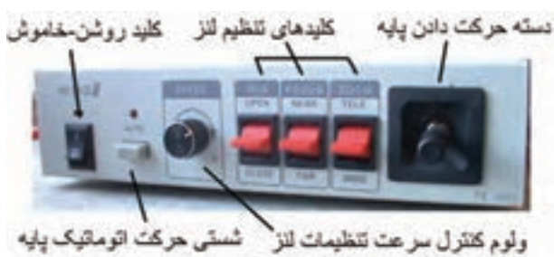
شکل ۳-۵۵ قسمت‌های مختلف جلو کنترل‌کننده
