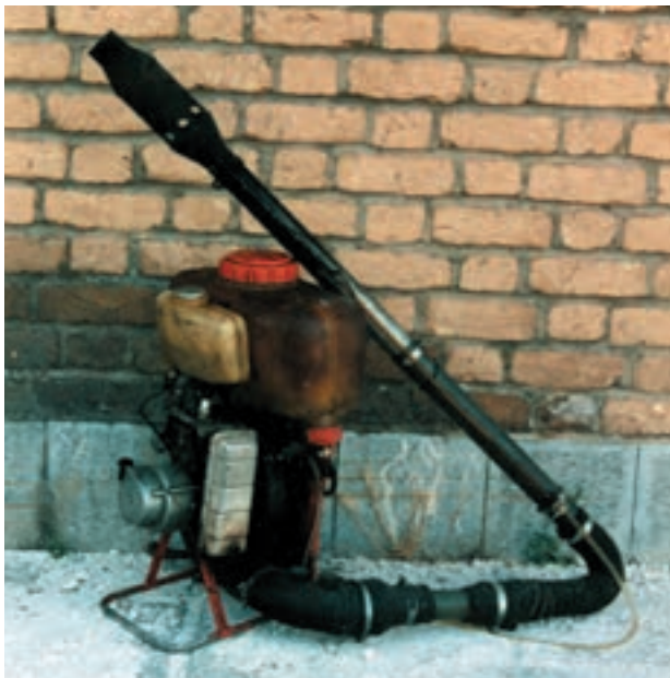
شعله افکن جهت حرارت دادن
