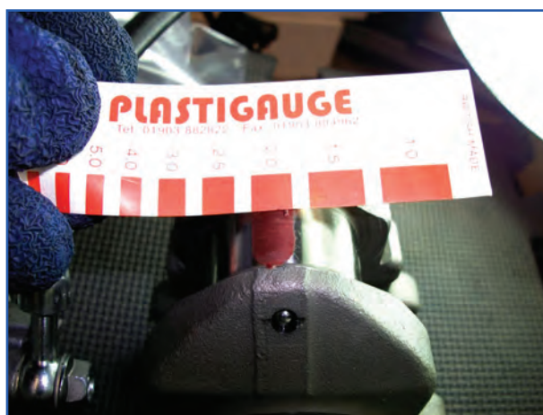
شکل ۱۷۶-۴ اندازه گیری دو بهنی پلاستی گیج شابلون
