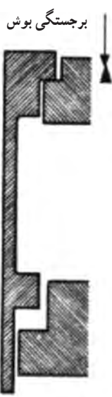
شکل ۱۴۵-۴ اندازه گیری بیرون زدگی بوش از روی سیلندر
