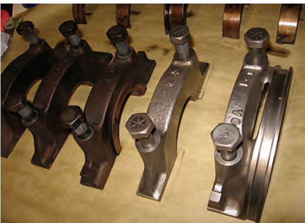
شکل ۱۵۴-۴- چیدن کپه یاتاقان‌ها
