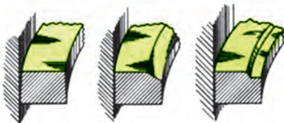
شکل ۴-۱۳۲- فرم خاص در لبه داخلی رینگ
