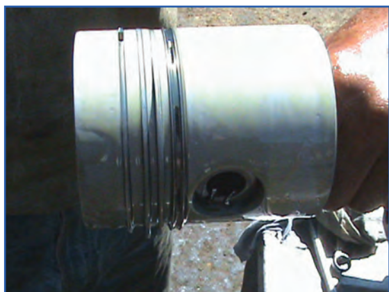
شکل ۱۴۰-۴ روغن‌کاری همه رینگ‌ها و پیستون
