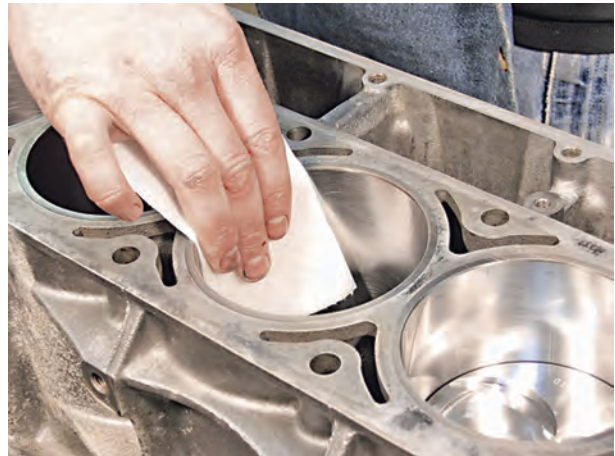
شکل ۴-۲۸- تمیز کردن داخل سیلندر
