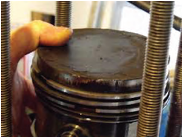
شکل ۴-۲۷- رسوبات کربن روی سطح پیستون
