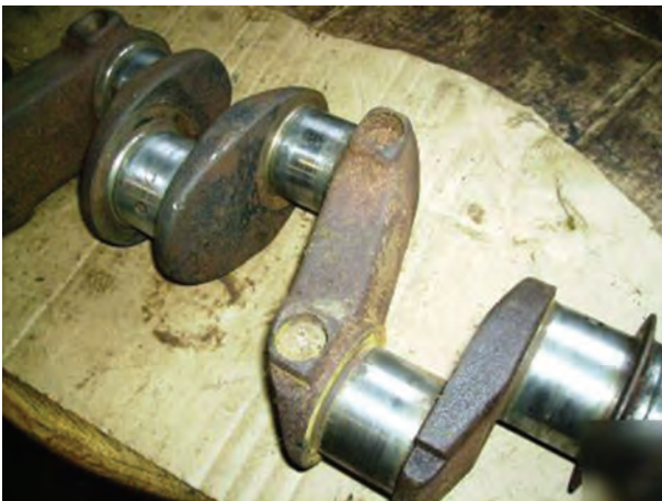
شکل ۴-۳۰- میل لنگ با رسوبات کربن
