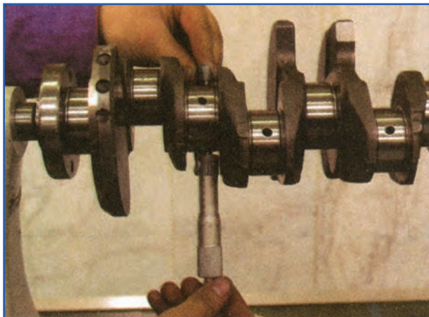
شکل ۱۶۲-۴ اندازه گیری قطر محورها میل لنگ
