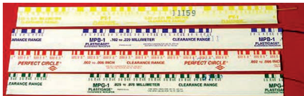
شکل ۱۷۸-۴ انواع پلاستیک گیج
