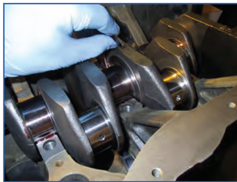
شکل ۱۸۳-۴ خارج کردن بغل یاتاقانی
