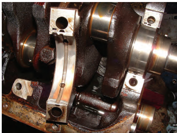
شکل ۱۸۲-۴ باز کردن کپه یاتاقان ثابت
