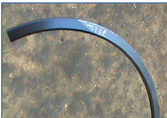
شکل ۴-۱۳۴- علامت TOP روی رینگ
