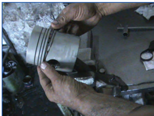
شکل ۱۳۸-۴ جازدن رینگ با دست
