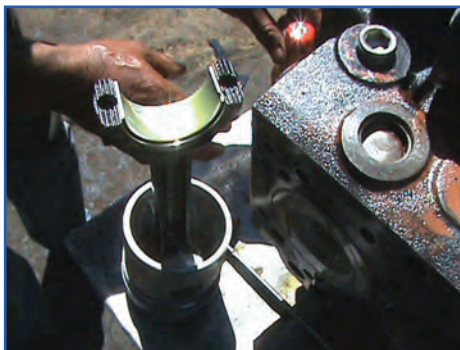
شکل ۱۹۲-۴ روغن‌کاری رینگ‌ها، پیستون و یاتاقان
