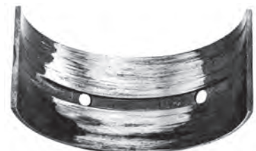
شکل ۴-۱۶۶ سایش یاتاقان به دلیل لقی کم بین میل‌لنگ و یاتاقان
