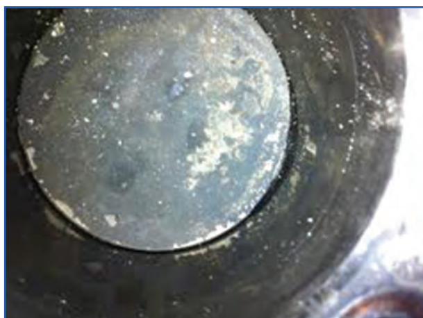
شکل ۲۰۶-۴ رسوبات کربن روی سطح پیستون
