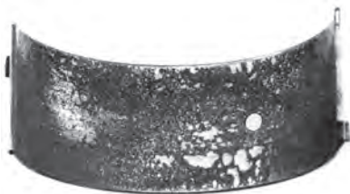
شکل ۴-۱۶۸ اثرات سوختگی روی یاتاقان
