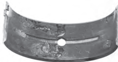
شکل ۴-۱۶۷ نقاط ذوب‌شده روی یاتاقان
