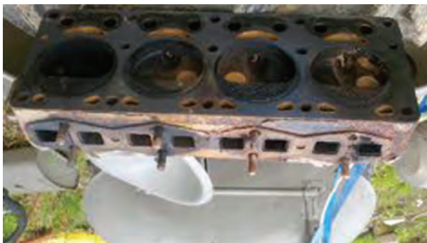
شکل ۴-۲۹- رسوبات کربن سطح سرسیلندر
