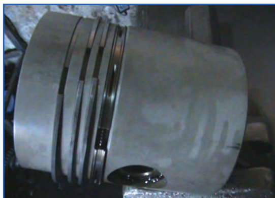
شکل ۱۳۹-۴ ترتیب قرار گرفتن رینگ‌ها روی شیار پیستون
