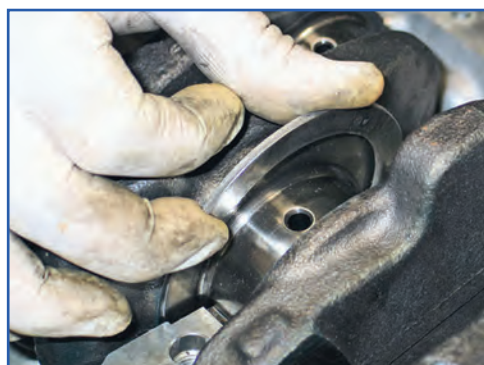
شکل ۱۸۴-۴ جازدن بغل یاتاقانی
