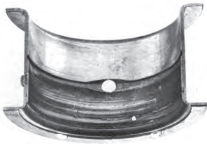
شکل ۴-۱۶۵ خط به دلیل نفوذ ذرات ریز و درشت بین میل‌لنگ و یاتاقان
