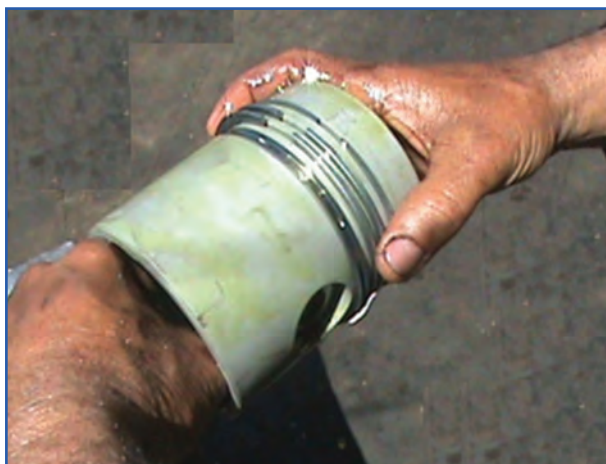
شکل ۱۹۶-۴- تنظیم کردن دهانه رینگ‌ها
