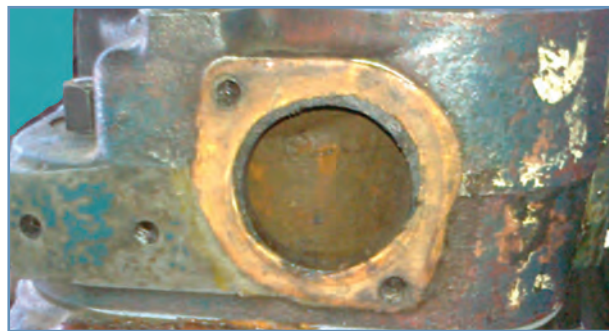
شکل ۲۳-۳ - واشر ترموستات قبلی
