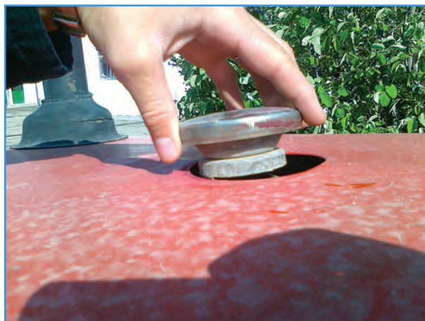
شکل ۷-۳- باز کردن در رادیاتور تراکتور MF285
