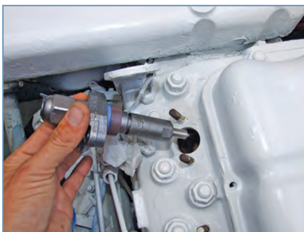
شکل ۲۳-۴ خارج کردن انژکتور
