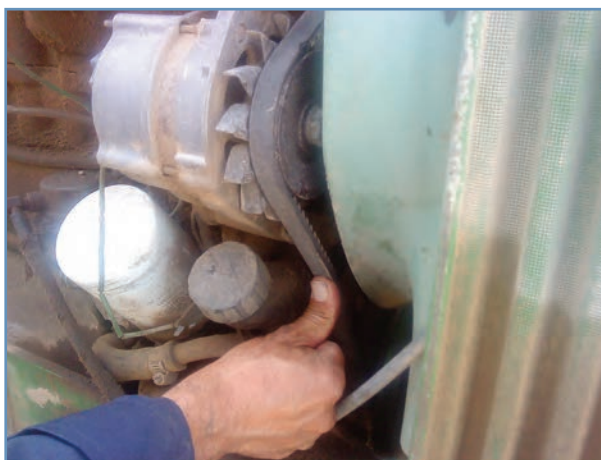
شکل ۲۸-۳ اندازه‌گیری کشش تسمه با فشار انگشت
