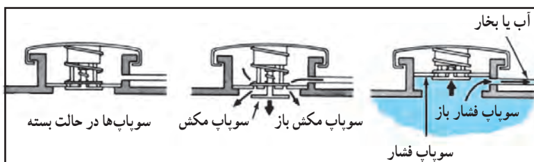
الف) وضعیت سوآپ‌های در رادیاتور
