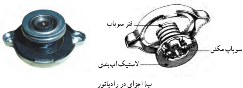
شکل ۳-۵- در رادیاتور و طرز کار سوآپ‌های آن
