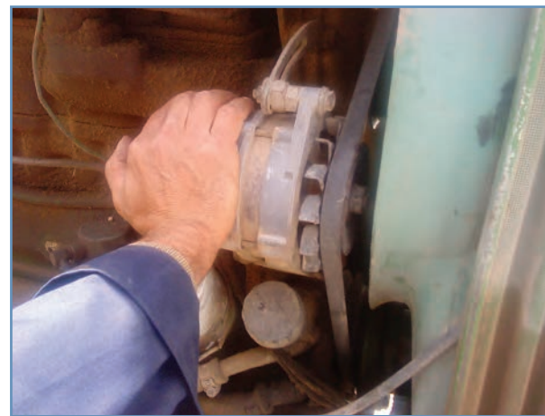
شکل ۳۰-۳ فشار دادن مولد به سمت موتور
