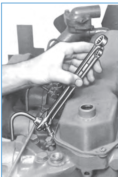
شکل ۲۲-۴ باز کردن لوله‌های فشارقوی انژکتورها
