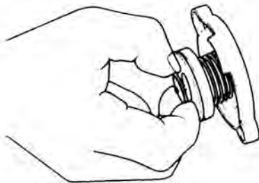
شکل ۱۷-۳- آزمون سوپاپ مکش در رادیاتور
