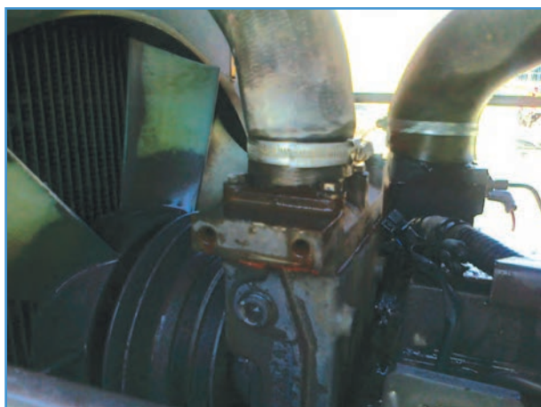
شکل ۱۱-۳- محل بست شیلنگ محفظه ترموستات
