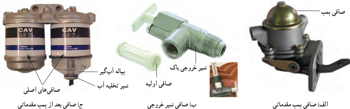
شکل ۹-۴- انواع صافی گازوئیل
