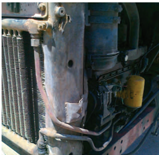
شکل ۱۲-۳- محل مهره‌های رادیاتور روغن
