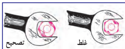
شکل ۲۹-۳ طرز درگیر کردن آچار تخت با مهره
