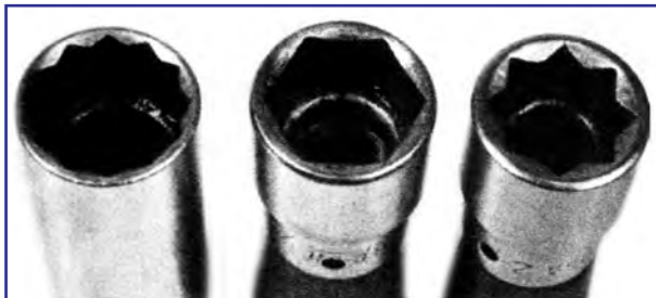
شکل ۳۵-۳- آچار بکس شش، هشت و دوازده گوش
