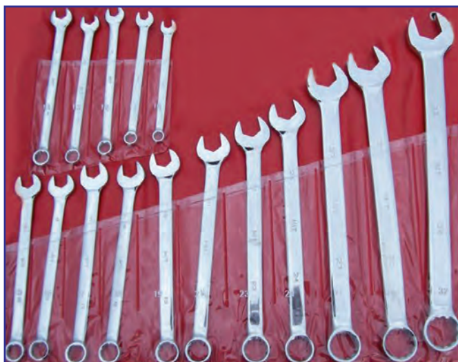
شکل ۳۳-۳- یک سری آچار یک سر رینگ
