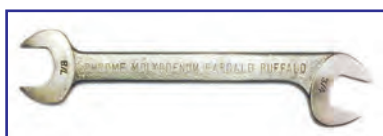
شکل ۲۸-۳ آچار تخت با سر زاویه دار (اینگی)
