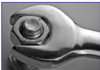
شکل ۲۸-۳ آچار تخت با سر زاویه دار (اینگی)
