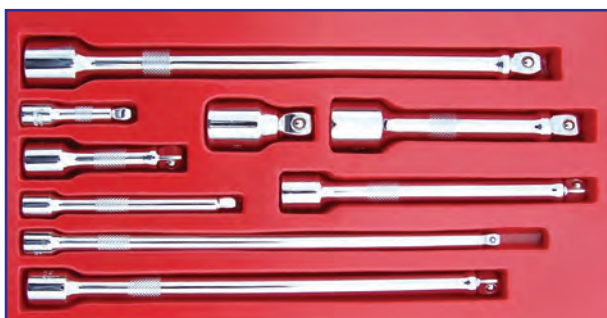
شکل ۴۷-۳- انواع رابط بکس
