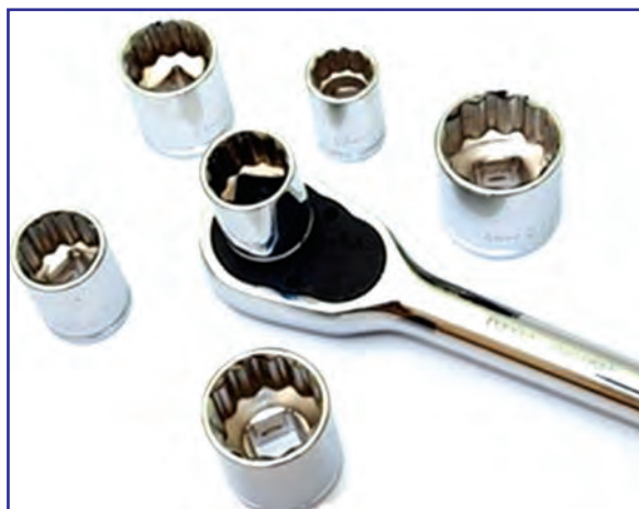
شکل ۴۸-۳ اتصال بکس به دسته بکس جفجغه ای
