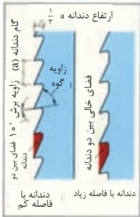
شکل ۱- تیغ اره نواری مناسب برش های طولی
