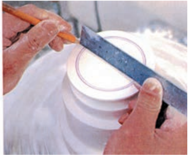
۱۳- گج گذاری روی پایه - تراشیدن و اندازه گیری برای تراشهای بعدی
