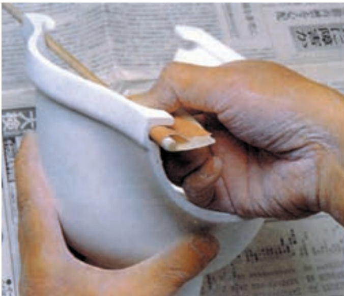
۱۹- پس از گرفتن گچ، با چکش به آرامی و با دقت قالب را شکسته و قطعه را خارج سازید.
