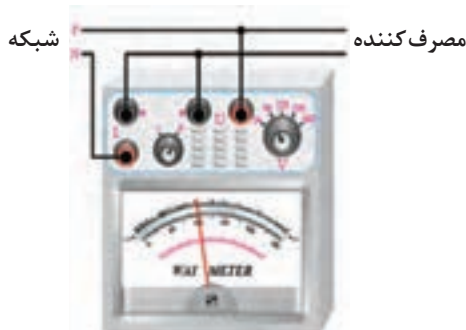
شکل ۷۸ - نحوه اتصال وات‌متر به شبکه برق شهر و مصرف‌کننده
