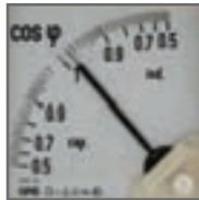
شکل ۸۰ - کسینوس فی متر دو طرفه
