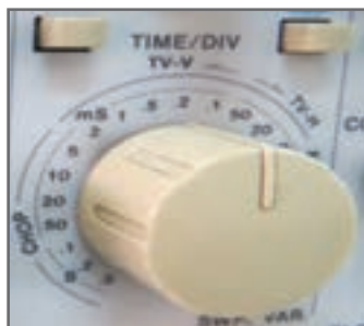
T = (\text{تعداد خانه‌های افقی یک سیکل}) \times (\text{عدد کلید سلکتور} / \text{TIME} / \text{DIV})
